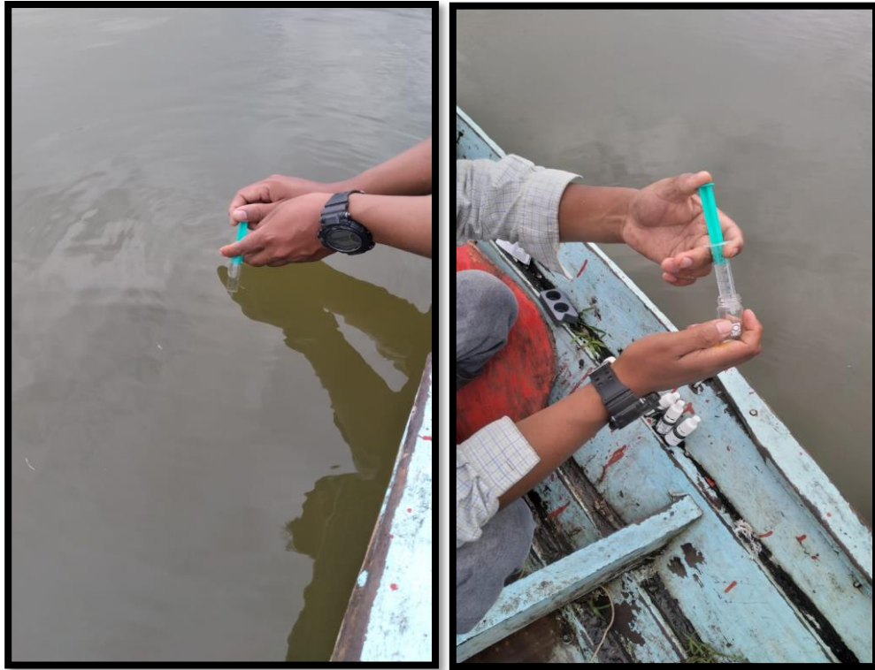
Figura 57. Extracción de una muestra de agua de la Laguna de los Milagros para evaluar el oxígeno disuelto y el amonio.
