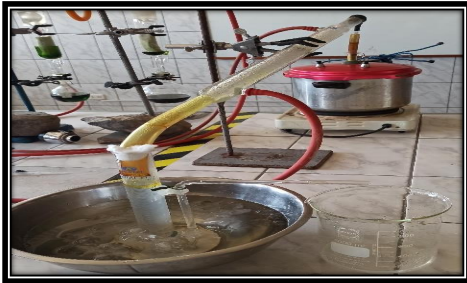
Figura 10. Destilación por arrastre de vapor para obtención del aceite esencial
