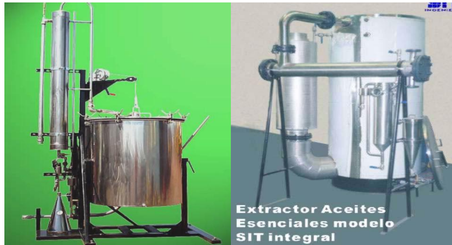
Figura N° 08.- Equipos a nivel piloto de acero inoxidable: con generador externo de 150 L. (izquierda), modelo SIT integral con generador acoplado al hidroddestilador de 500 L. (derecha).
