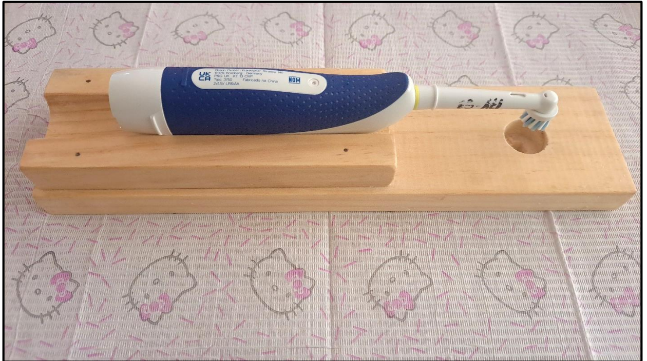
Fot. 19.- Estructura de madera para colocación de Cepillo eléctrico. Fuente y Elaboración. - Gordón Jácome Diego Danilo, 2021.
