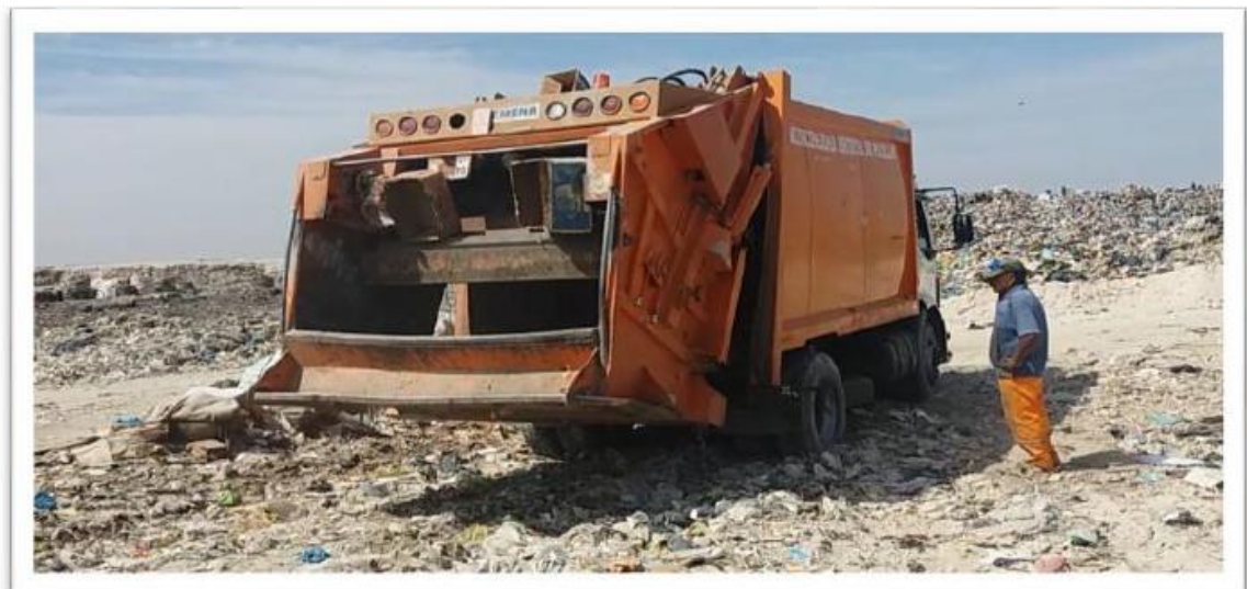
Carro compactador en el botadero municipal
