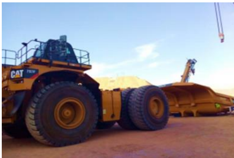
Figura 44. Foto armado de tolva en camión 979F
