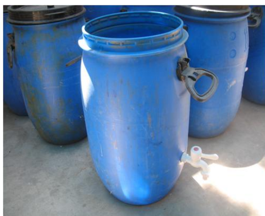
Figura 29: Cilindro del biodigestor con un caño en su parte inferior lateral para toma de muestra.
