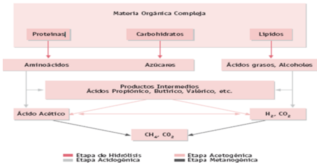
Figura 1: Etapas del proceso de producción de biogás.
