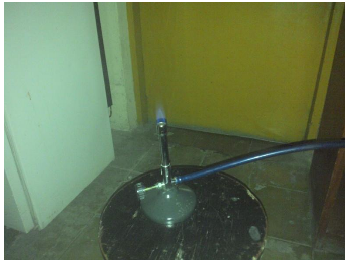
Figura 67: Biogás proveniente del biodigestor encendido en el mechero Bunsen originando una llama de buena calidad.
