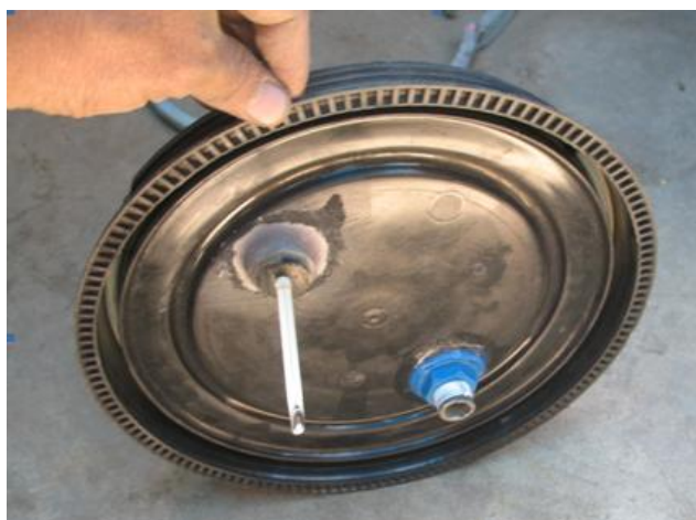
Figura 33: Tapa del biodigestor en su parte interna con el termómetro y la llave de paso de descarga de biogás en el instalado
