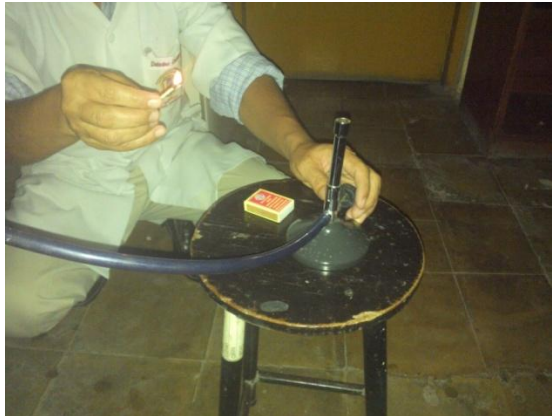
Figura 65: Biogás conducido desde el biodigestor al mechero Bunsen, listo para ser quemado.
