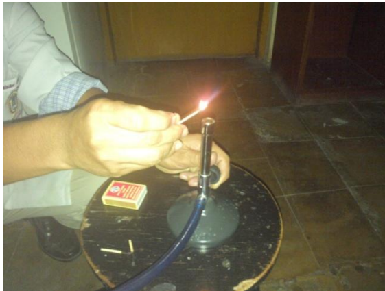
Figura 66: Biogás proveniente del biodigestor que está siendo prendido en el mechero Bunsen.
