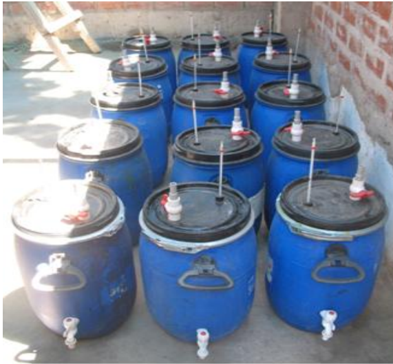
Figura 34: Biodigestores contruidos para la experimentación
