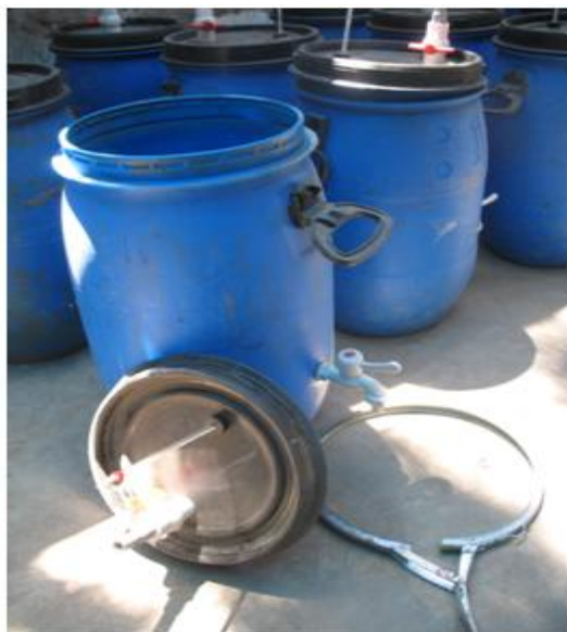
Figura 28: Componentes del biodigestor: cilindro, cincho y tapa
