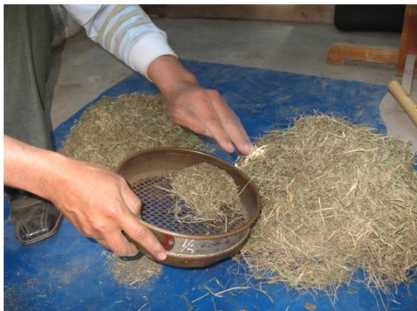
Figura 36: Grass reducido en tamaño que es colocado en tamizador de 0.6
