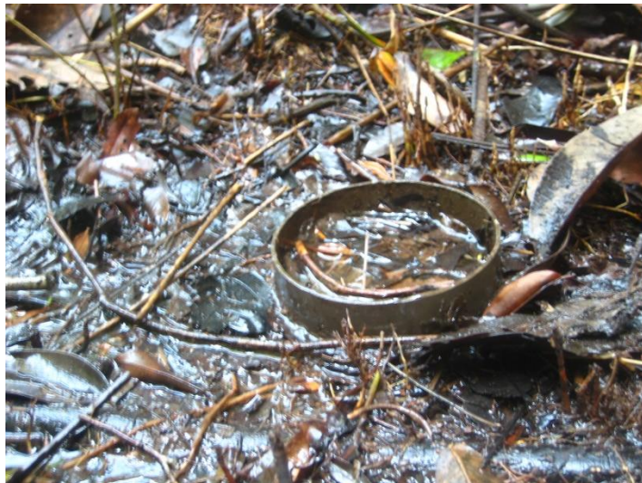
Anexo 22. Fotografía del tubo de pvc insertado en el suelo.
