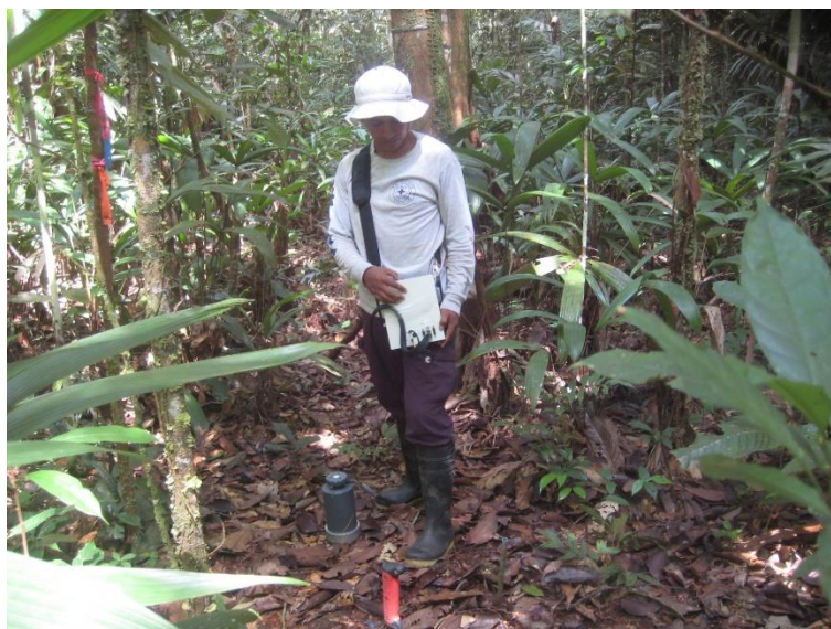
Anexo 24. Fotografía de la toma de datos de la respiración del suelo con el EGM-4.
