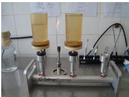
Foto N° 5. Filtración de la muestra en el equipo de filtración.
