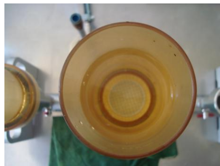
Foto N° 4. Filtros de membrana colocados en el embudo de filtración
