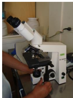
Foto N° 11. El sedimento obtenido se coloca en láminas porta objetos y se las observa al microscopio.
