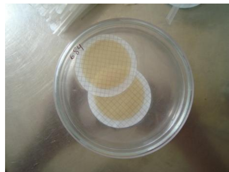
Foto N° 6. Los filtros se van colocando en una placa petri con solución salina.
