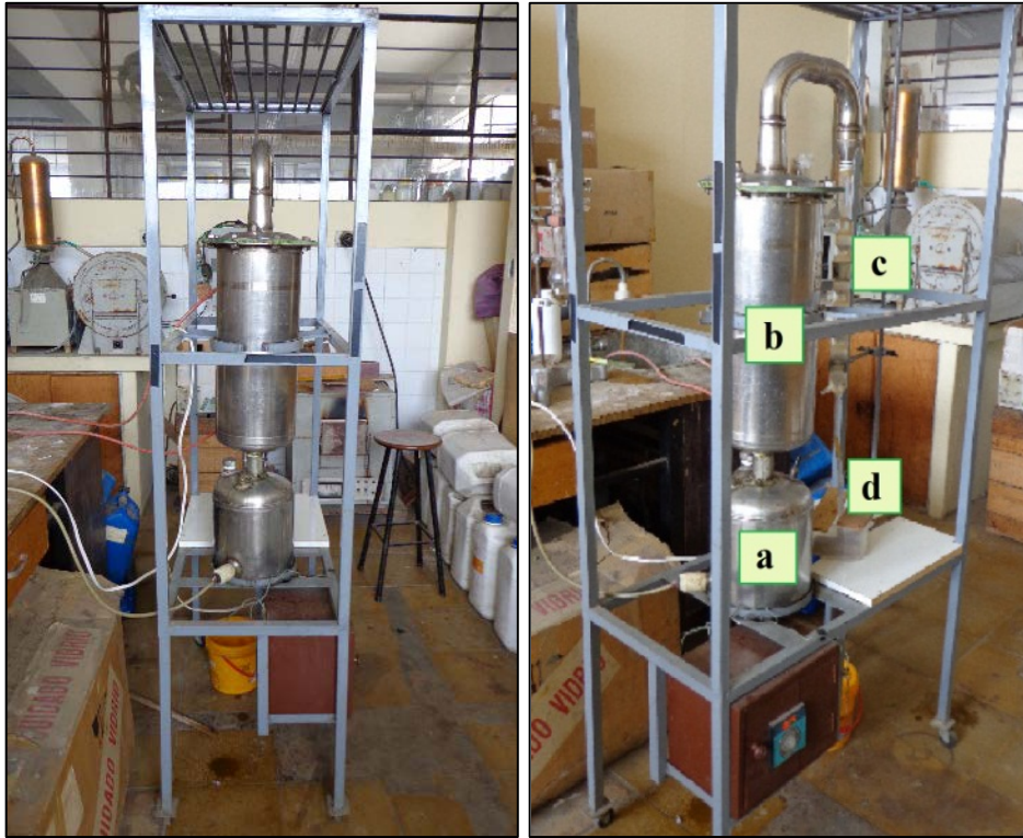
Figura N° 02. Equipo de extracción por arrastre de vapor, que consta de las siguientes partes: a) caldera, b) un alambique, c) un condensador de vidrio tipo serpentín, d) un colector de líquidos dispuesto inmediatamente a la salida del condensador.
