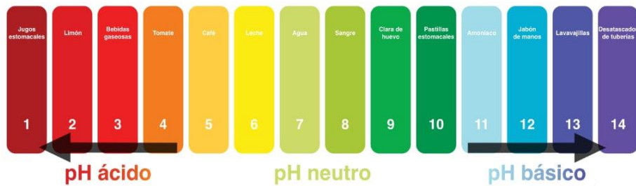
Figura 3: Escala de Potencial de Hidrógeno (pH) distribuido en sus medios ácido, neutro y básico o alcalino
