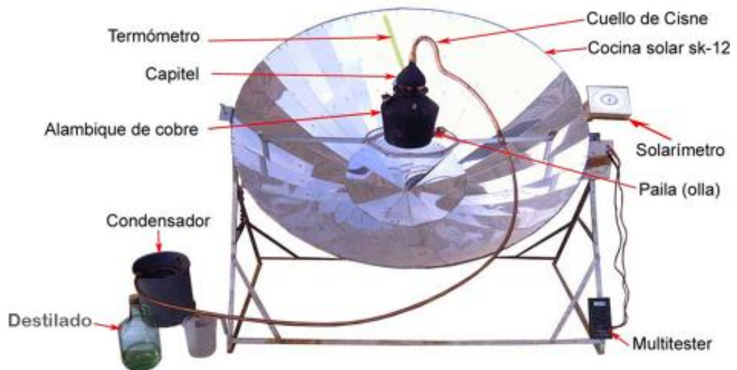
Figura 5. Componentes del destilador solar de fermentados sk-12 con olla de cobre sin estaño de 5 L de capacidad.
