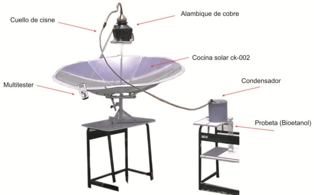
Figura 3. Componentes del destilador solar de fermentados ck-002 con olla de cobre sin estaño de 5 L de capacidad.
