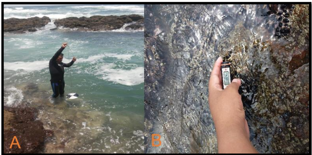
Figura 24. A. Medición de turbidez con el disco de SECHI, B. Toma de temperatura de agua.
