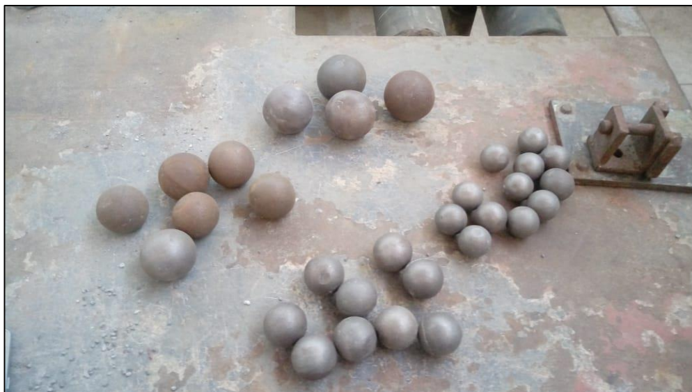
Figura 15. Identificación de las bolas para la molienda Fuente: Recolección propia
