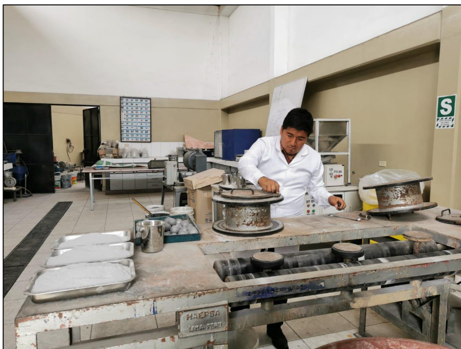
Figura 16. Molinos utilizados para la liberación del mineral refractario Fuente: Recolección del autor.
