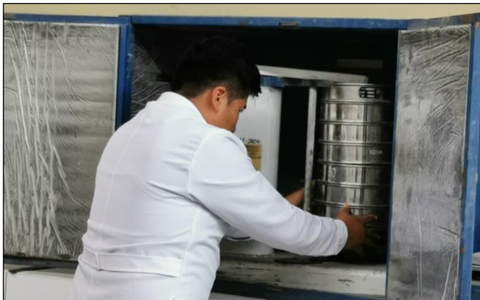
Figura 21. Máquina del Rotap para la realización del ANGRA Fuente: Recolección propia
