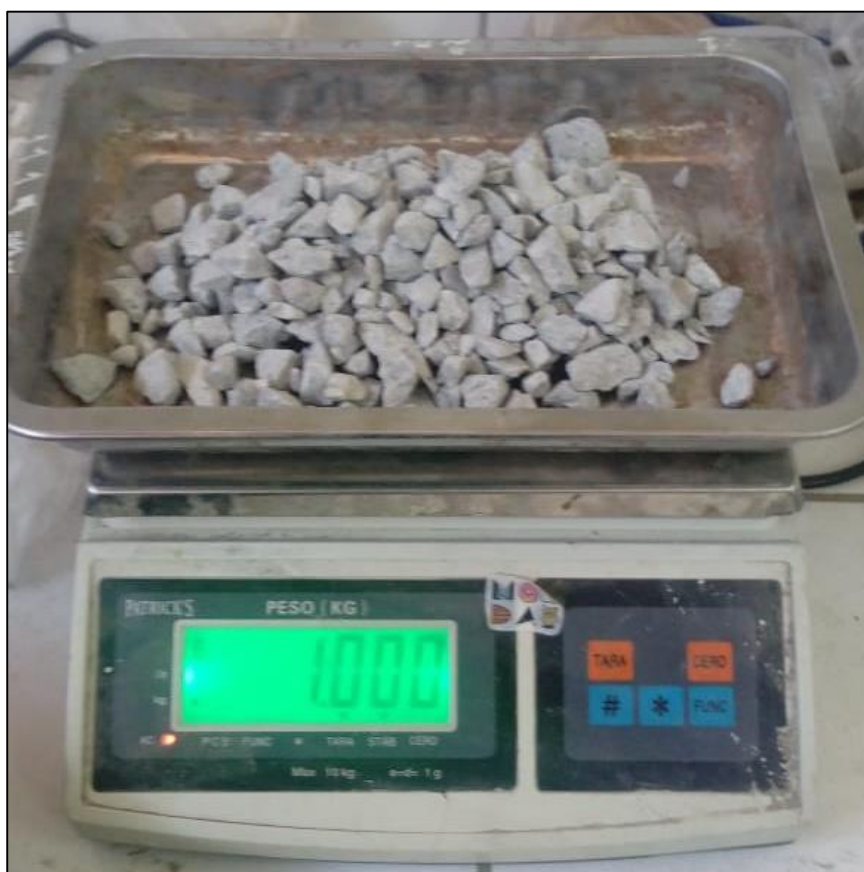
Figura 14. Pesado del mineral refractario Fuente: Recolección propia
