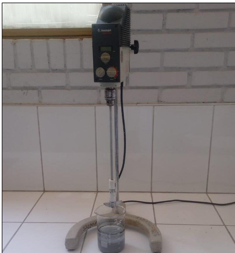
Figura 22. Agitación del mineral refractario Fuente: Recolección propia
