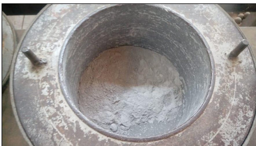
Figura 18. Mineral como resultado de la molienda Fuente: Recolección propia
