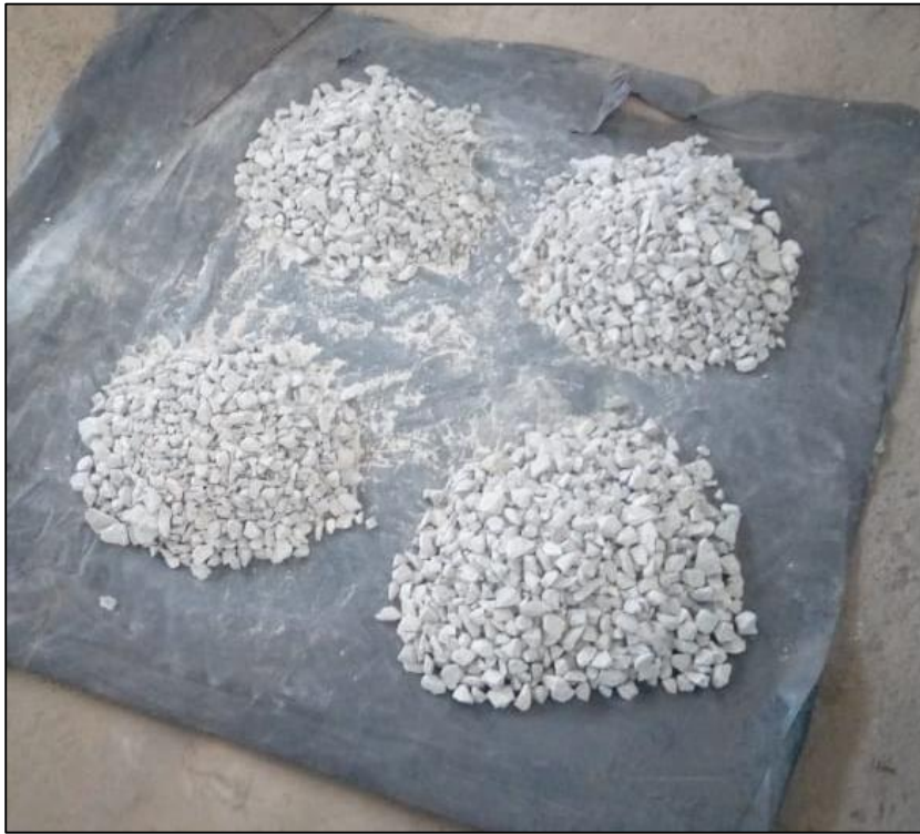
Figura 13. Cuarteo del mineral Fuente: Recolección propia
