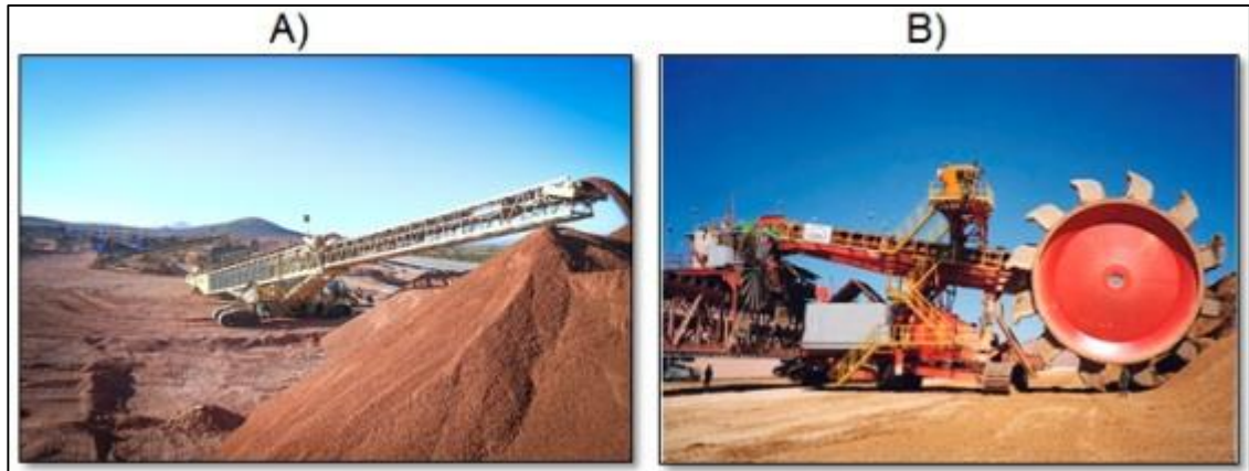
Figura 7. Equipo mecanizado para la carga y descarga de mineral en pilas de lixiviación. A) Apilador móvil; B) Rotopala para descarga de rípios, minera Radomiro Tomic, Chile (10745 t/h) Fuente: Direct Industry, 2014
