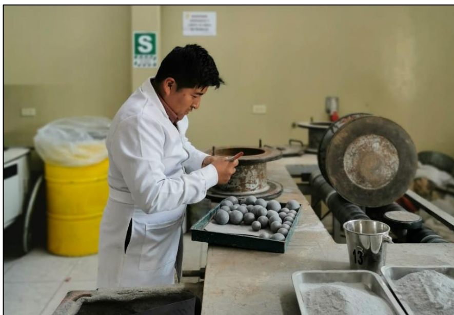
Figura 17. Limpieza de las bolas culminada la molienda Fuente: Recolección propia
