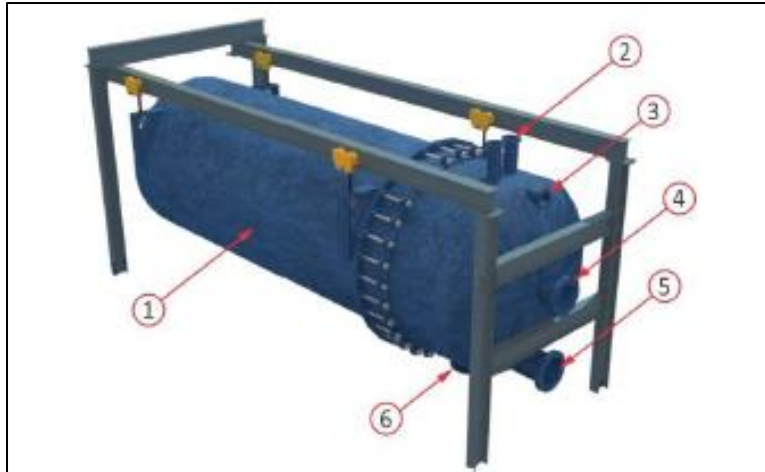
Tanque del Filtro Clarificador
