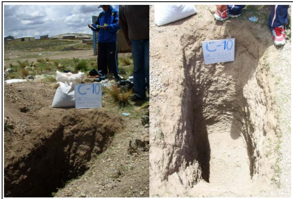
Foto 17. Vista y perfil estratigráfico de la calicata C-10, ubicado al posterior del Colegio Mazacruz.
