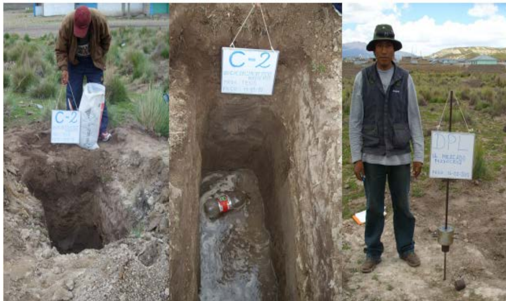
Foto 9. Vista y perfil estratigráfico de la calicata C-2, ubicado en Barrio 3 de Mayo al posterior del Mercado Mazocruz, el nivel freático está a 1,70 m de profundidad. Vista del ensayo DPL.
