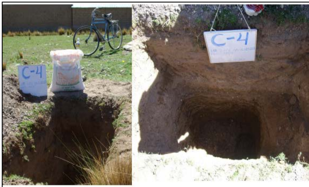
Foto 11. Vista y perfil estratigráfico de la calicata C-4, ubicado en Barrio Alianza y que alcanzó una profundidad de exploración de 2 m
