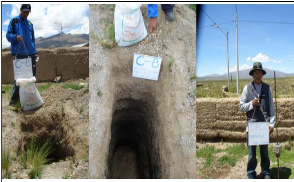
Foto 15. Vista y perfil estratigráfico de la calicata C-8, ubicado en la Av. El Niño a 20 m del local de Barrio Alianza, en esta zona se realizó ensayo de penetración dinámica (DPL) hasta una profundidad de 2,9 m
