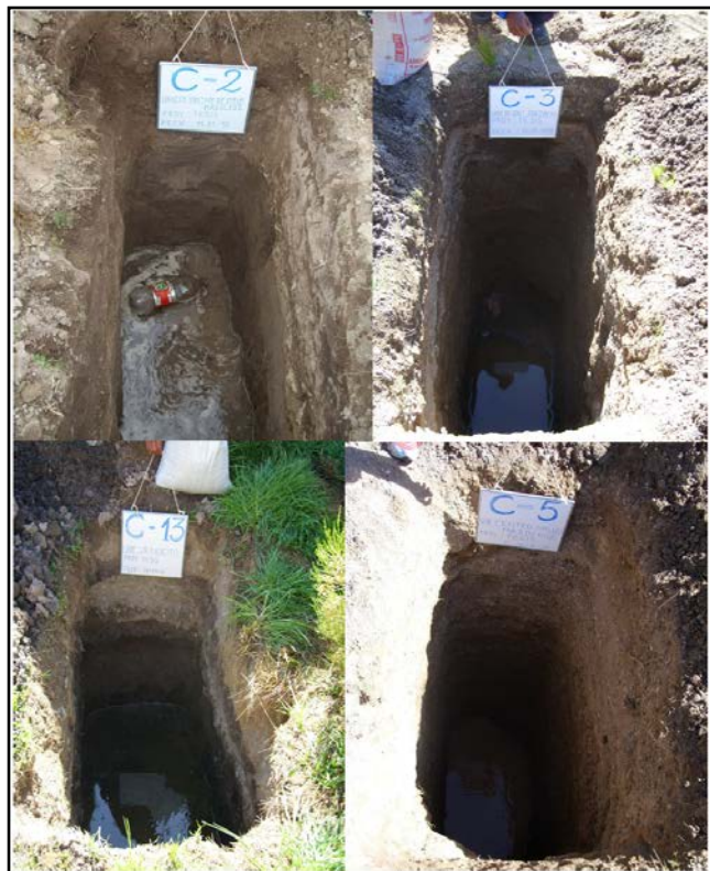
Foto 7. Vista de Nivel Freático. Hidrogeológicamente la zona de estudio presenta Nivel Freático, se determinó de acuerdo a exploraciones geotécnicas realizadas en la Zona I, II, III, IV y V de la zona urbana de Mazocruz. El nivel freático está a una profundidad de 2,7; 2,2; 2,2; 1,7; 1 metros respectivamente. Dato tomado en época de precipitación pluvial fuerte.
