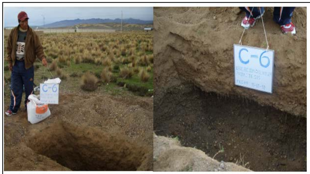
Foto 13. Vista y perfil estratigráfico de la calicata C-6, ubicado en Barrio Alianza, cuyo talud de suelo es inestable ocurre desprendimiento el cual no permite la excavación profunda
