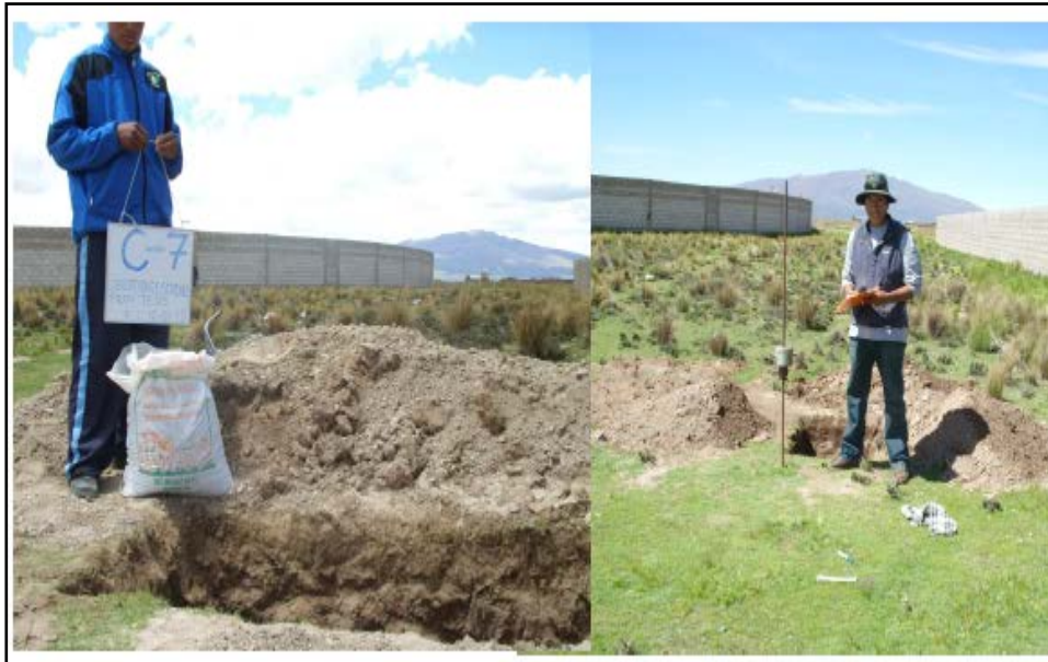
Foto 14. Vista de la calicata C-7, ubicada al posterior del estadio y campo ferial, en esta zona se realizó ensayos de DPL hasta una profundidad de 4 m
