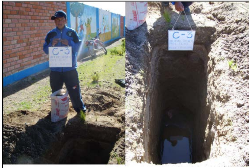
Foto 10. Vista y perfil estratigráfico de la calicata C-3, ubicado en Barrio 3 de Mayo al posterior del Jardín. Con nivel freático a 1,9 m y que alcanzó una profundidad de exploración de 2 m
