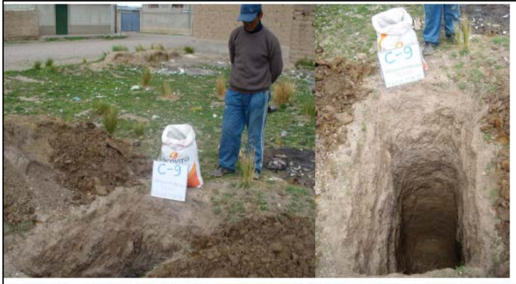
Foto 16. Vista y perfil estratigráfico de la calicata C-9, ubicado en Barrio 3 de Mayo – Jr. Santa Cruz, alcanza una profundidad de exploración de 2 m cuyo nivel freático está a 2 m.
