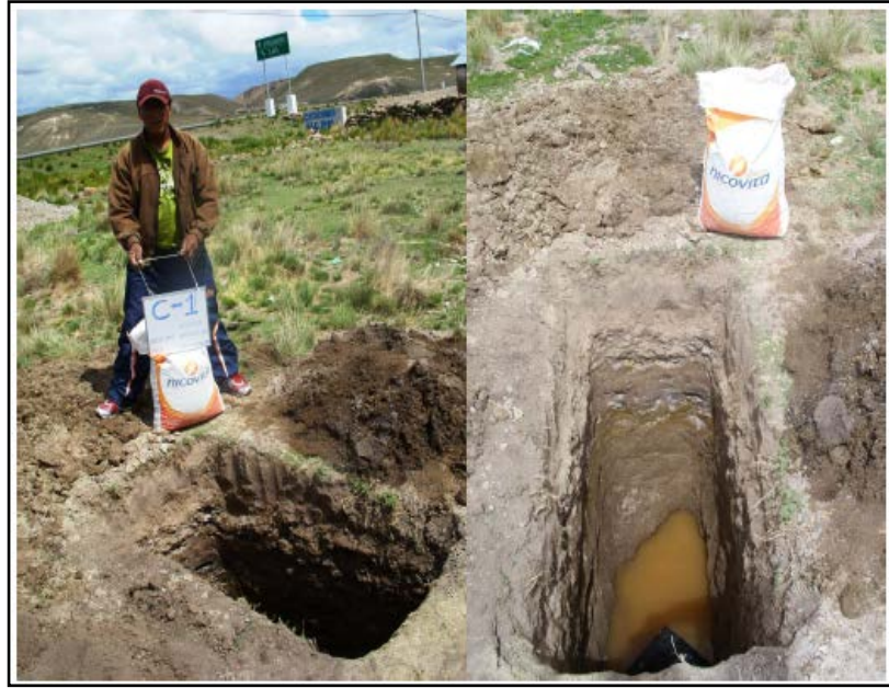
Foto 8. Vista y perfil estratigráfico de la calicata C-1, ubicado en Barrio 3 de Mayo al lado derecho de intersección de vía Mazocruz- Desaguadero y Mazocruz- llave, el nivel freático está a 1,70 m de profundidad.
