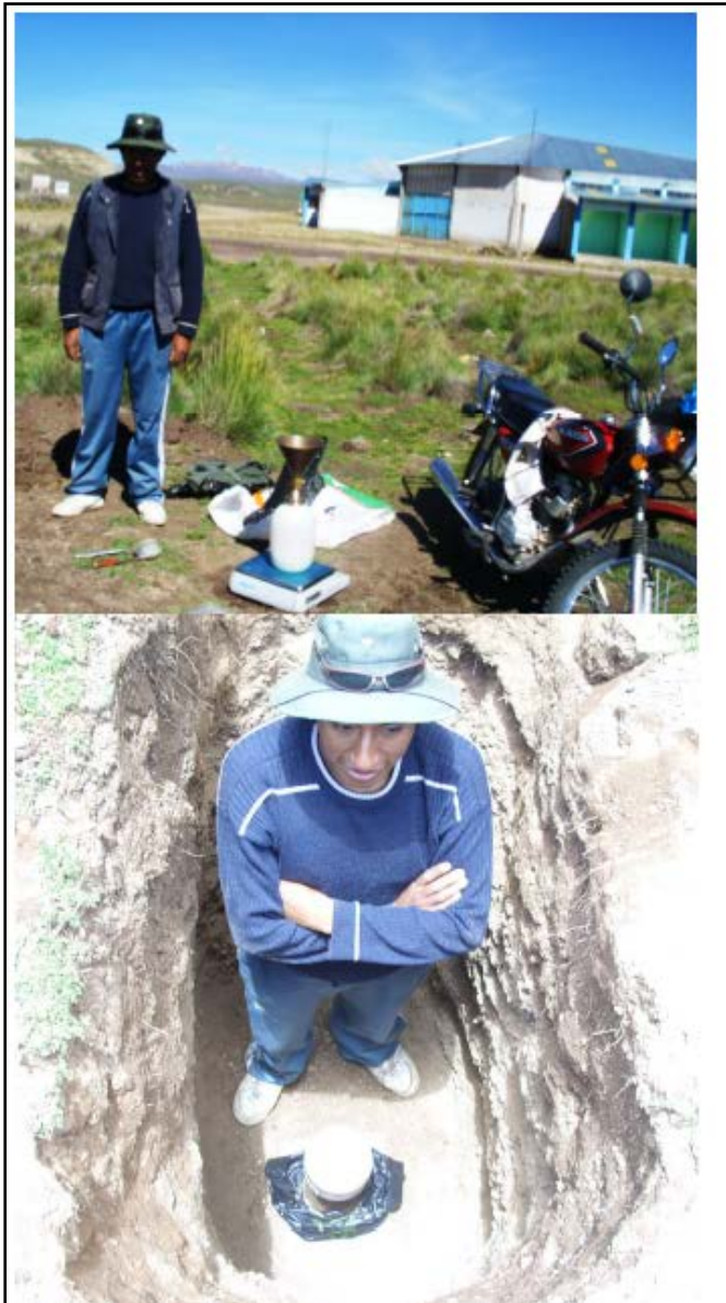
Foto 23. Vista de ensayo de densidad in situ, los ensayos fueron realizados en la zona urbana del pueblo de Mazocruz.
