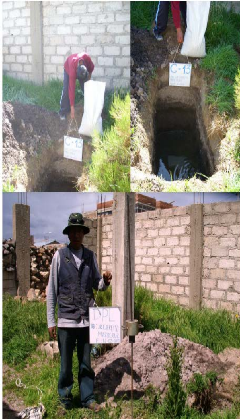
Foto 20. Vista y perfil estratigráfico de la calicata C-13, ubicado en Jr. Ejercito del barrio Esperanza. En esta zona se realizó ensayo de DPL. Cabe indicar que esta zona es bofedal.
