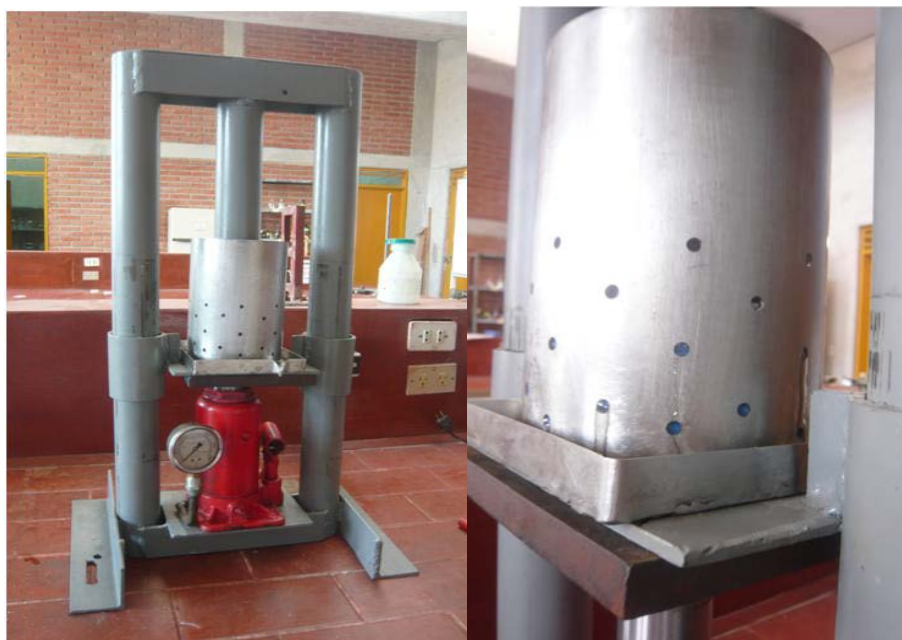
Figura 4. Prensa manual utilizada en la extracción de aceite de sachá inchi y detalle del escurrimiento.
