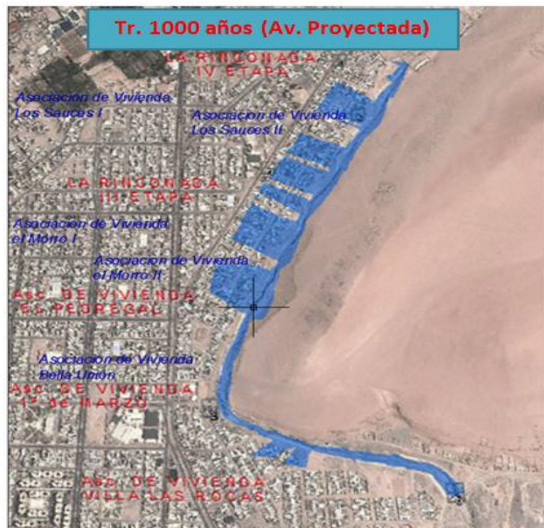
Figura 16: Se muestra que el caudal de 489,00\ m^3/s discurre generando varias zonas de inundación a lo largo del cauce.
