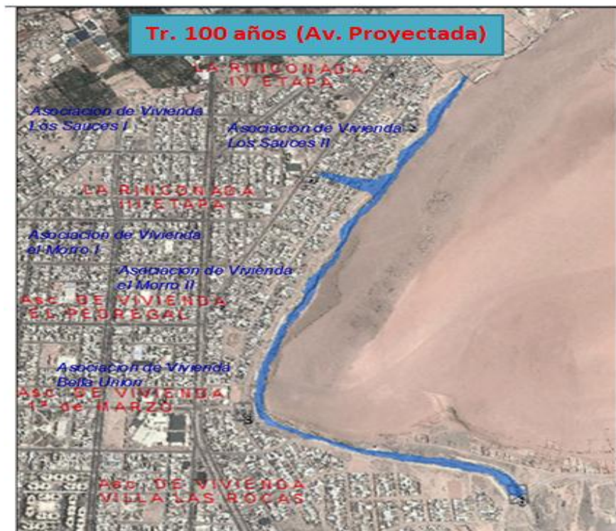
Figura 14: Se muestra que el caudal de 117,00 m 3 /s discurre generando zonas de inundación a partir de la progresiva 0+400.
