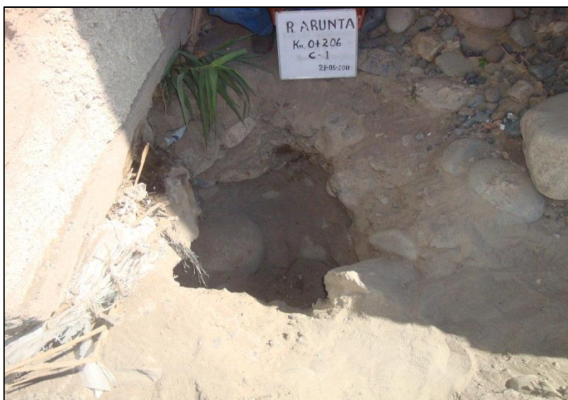
Figura 4 : Calicata N° 01, en la progresiva 0+206, muestra las gravas arenosas pobremente gradadas, cantos rodados y bolones.
