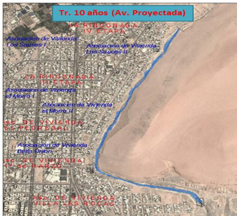
Figura 12: Se muestra que el caudal de 29,00 m 3 /s discurre sin generar zonas de inundación a lo largo del cauce.
