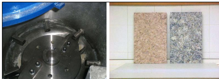
Imagen 35. Cuchillas del aglomerador y producto final
