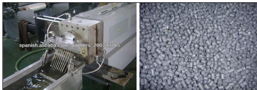
Imagen 37. Acción de peletización y producto final
