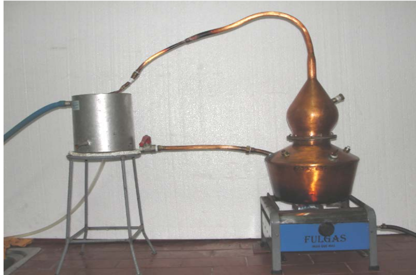
Figura 7. Alambique de cobre utilizado para la destilación Fuente: Elaboración propia (2012)
