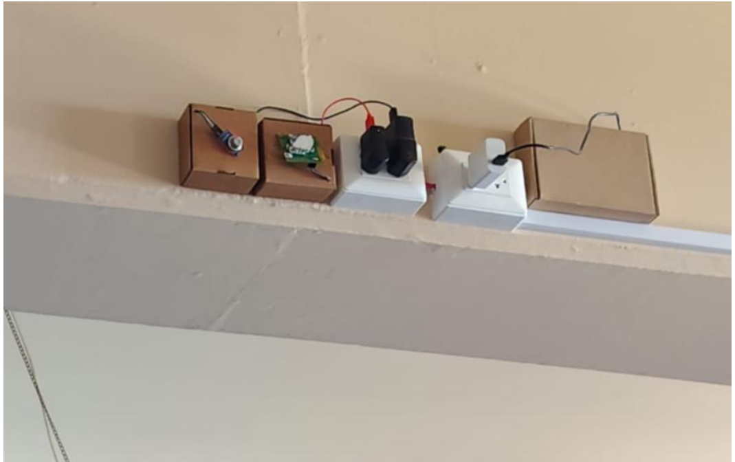
Figura N° 10: Ubicación del prototipo de sensor K30 y MQ135. Fuente: Propia
