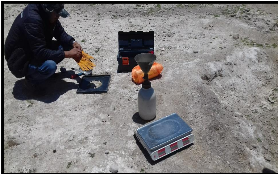
Fotografía 6. Ensayo de Densidad In Situ (Cono de Arena)
