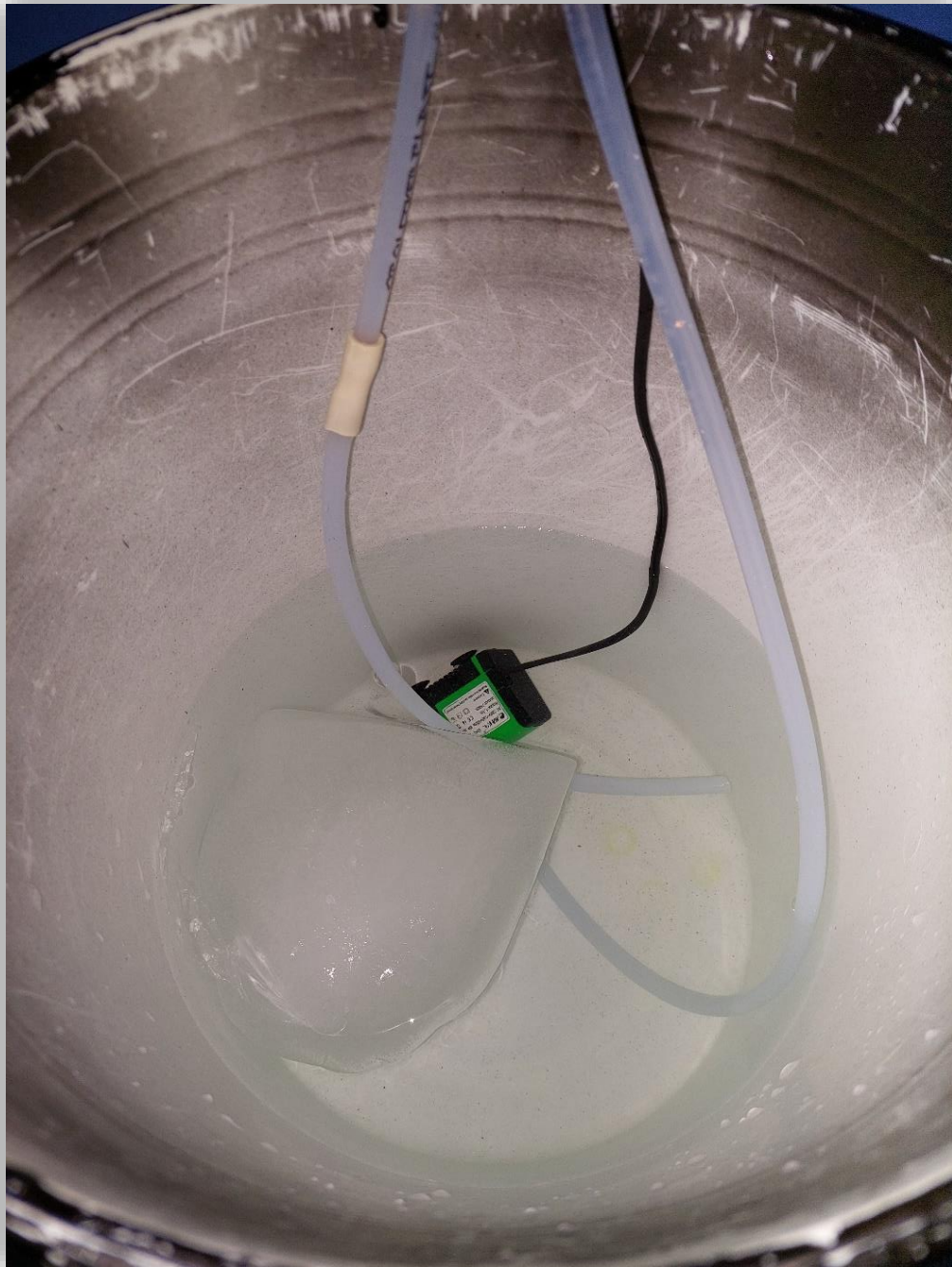
Anexo 21. Bomba de agua del sistema de refrigeración.
