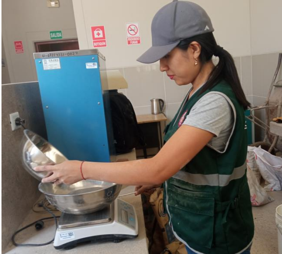
Pesado de insumos de los adoquines de concreto
