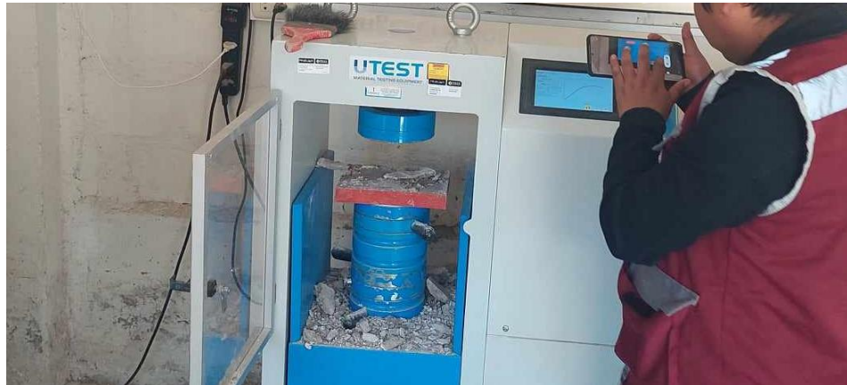
Figura 35: Ladrillo con 10% de PET - Resistencia a Compresión
