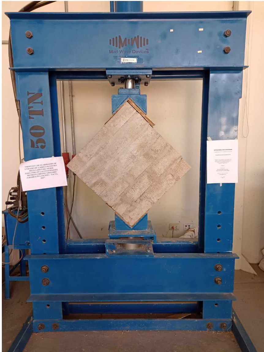
Figura 68: Rotura de murete de ladrillos con plástico PET
