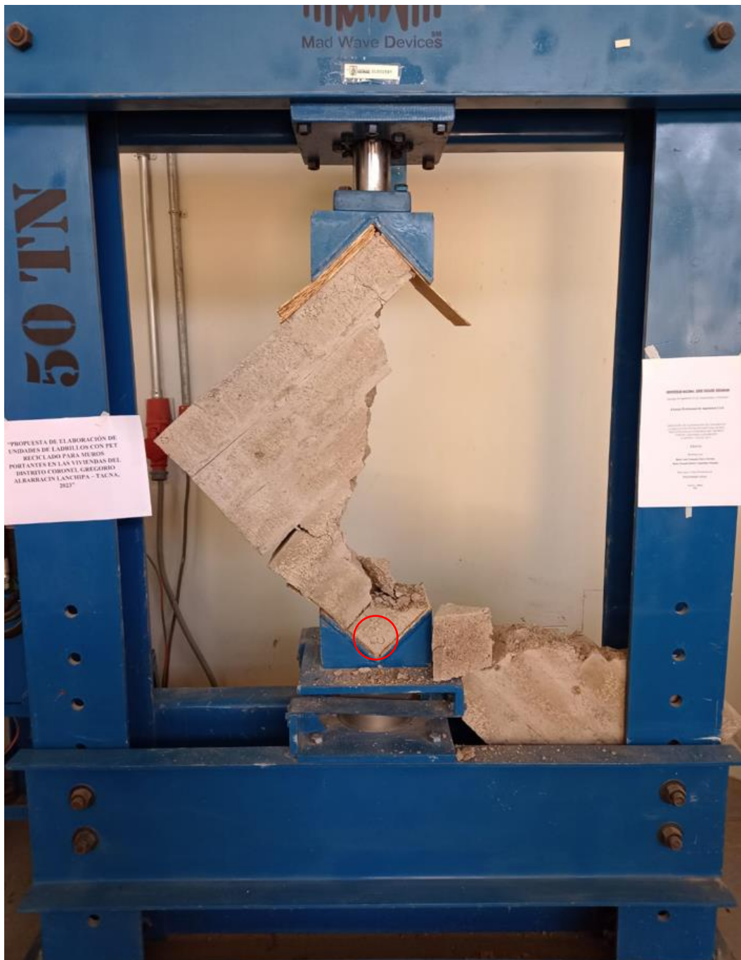
Figura 50: Rotura de murete con 6% de PET (plástico)
