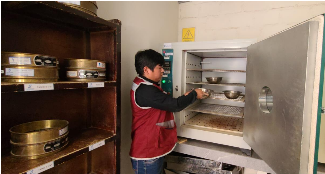
Figura 17: Taras colocadas al horno a secar por 24h.
