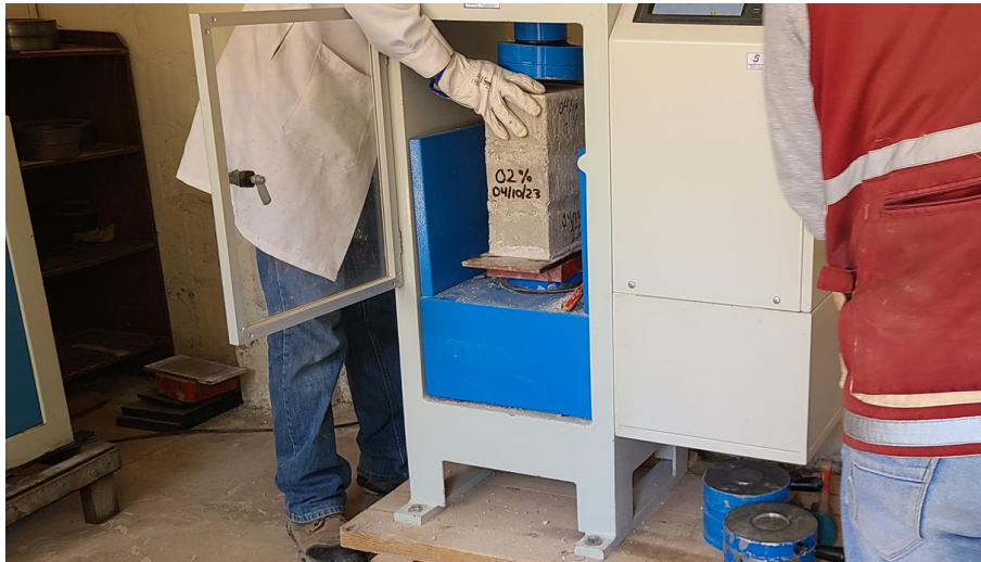
Figura 39: Pila con 2% de PET - Resistencia a Compresión
