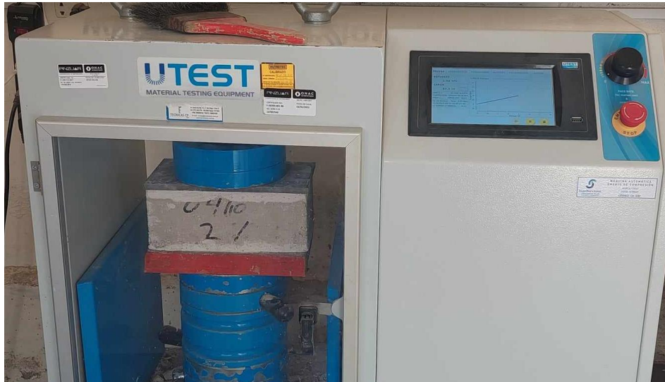
Figura 31: Ladrillo con 2% de PET - Resistencia a Compresión
