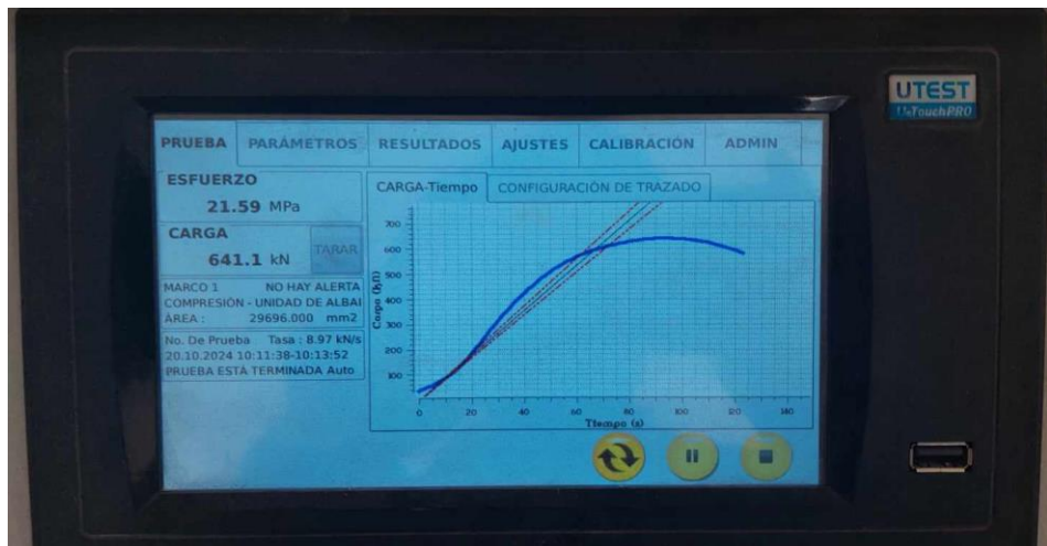
Figura 34: Grafica de resistencia a la compresión de ladrillo con 6% de PET
