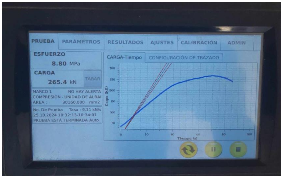
Figura 38: Grafica de resistencia a la compresión de Pila con 0% de PET
