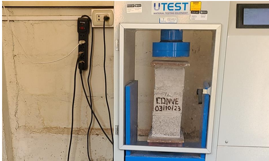
Figura 37: Pila con 0% de PET - Resistencia a Compresión
