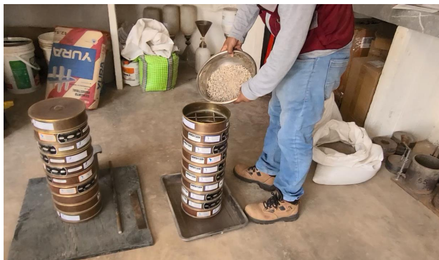
Figura 13: Ensayo de análisis granulométrico del agregado grueso
