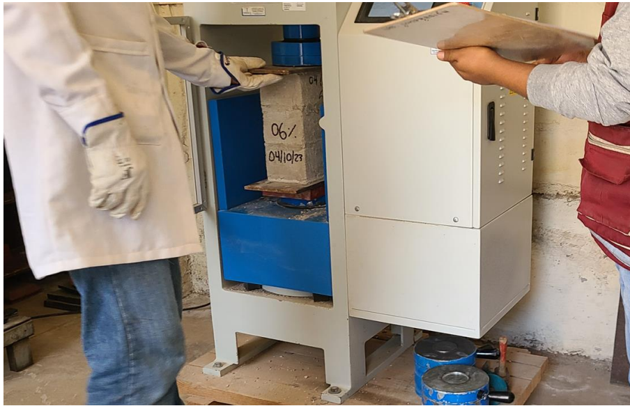
Figura 41: Pila con 6% de PET - Resistencia a Compresión
