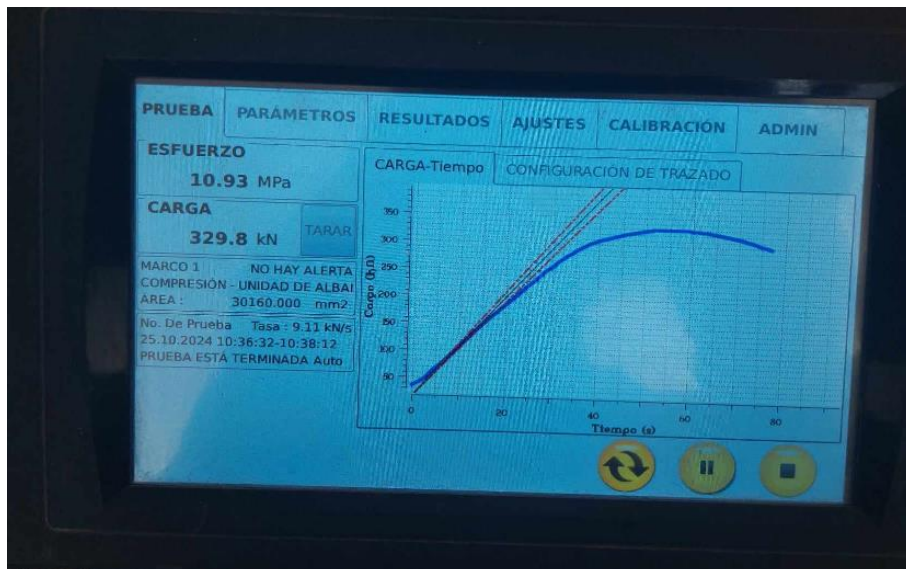
Figura 40: Grafica de resistencia a la compresión de Pila con 2% de PET
