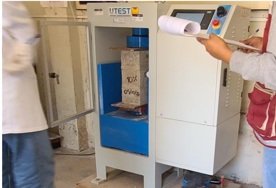
Figura 43: Pila con 10% de PET - Resistencia a Compresión
