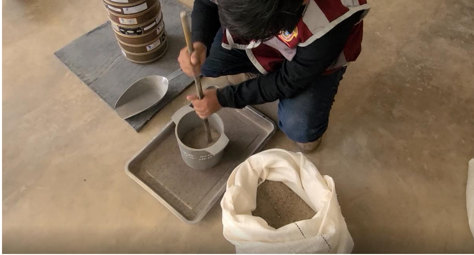
Figura 19: Varillado del Agregado Fino
