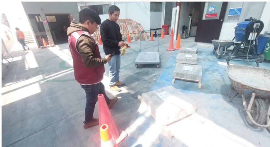
Figura 66: Muestras de muretes en laboratorio
