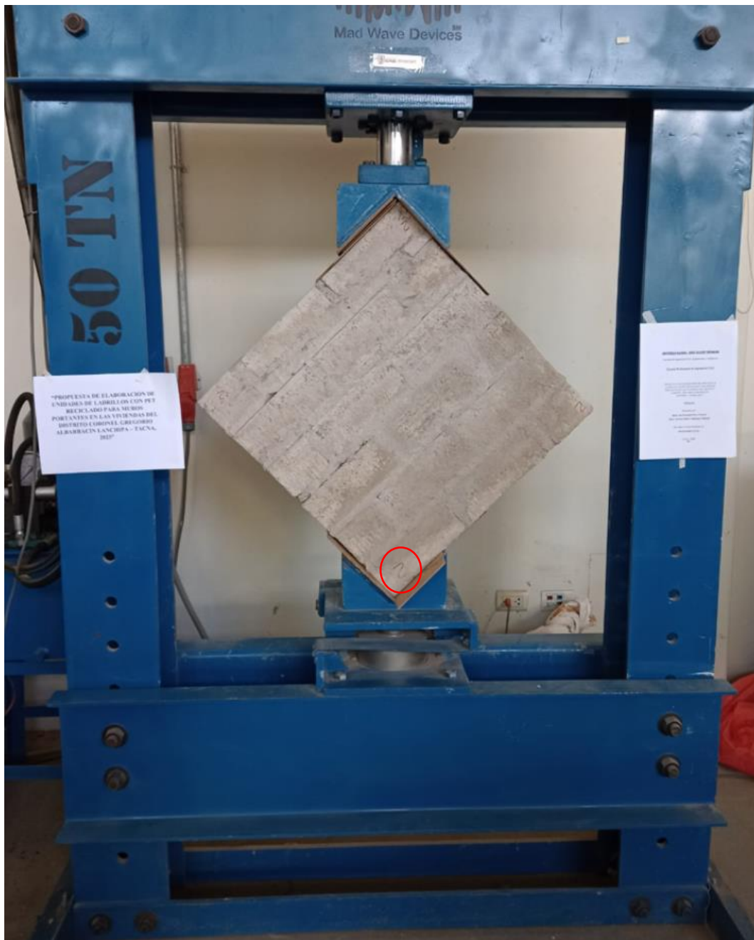
Figura 47: Ensayo a compresión diagonal de murete con 6% de PET (plástico)
