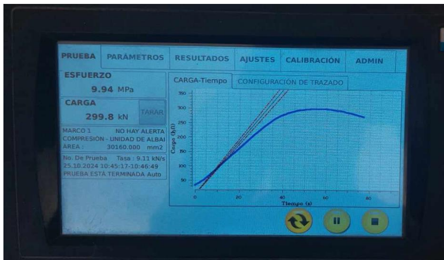
Figura 44: Grafica de resistencia a la compresión de Pila con 10% de PET
