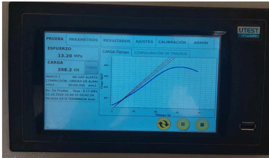
Figura 42: Gráfica de resistencia a la compresión de Pila con 6% de PET
