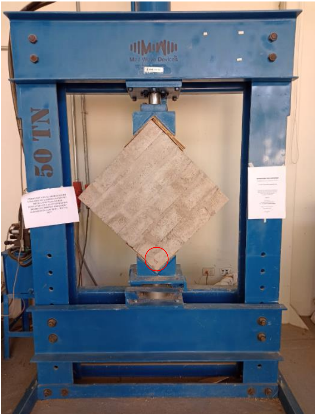
Figura 45: Ensayo a compresión diagonal de murete con 2% de PET (plástico)
