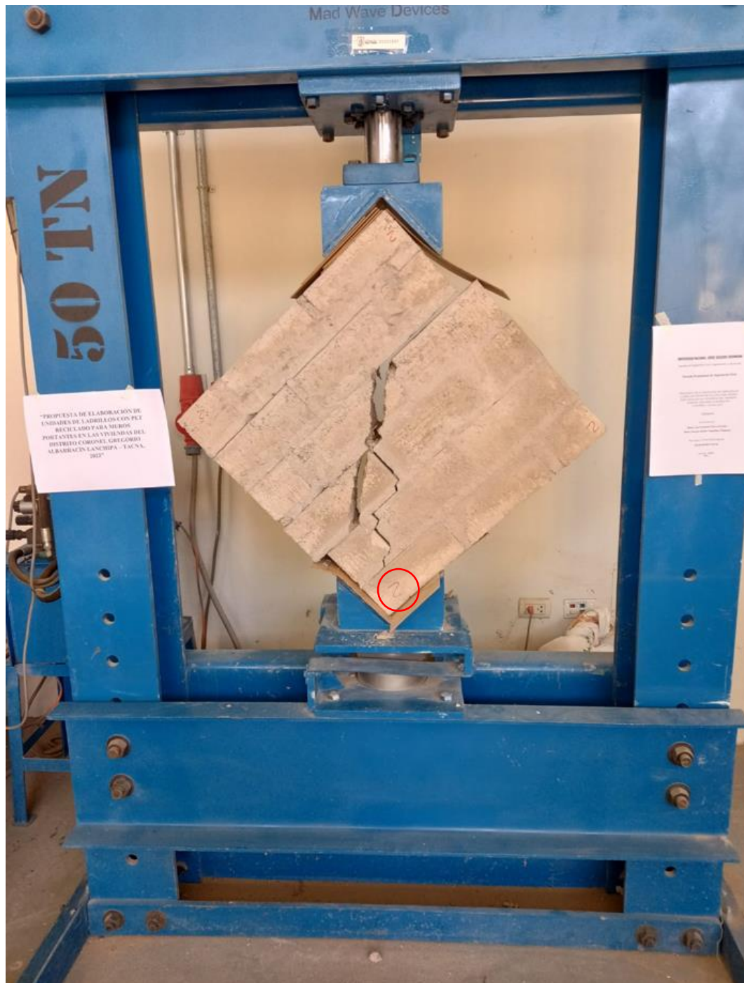
Figura 48: Rotura de murete con 6% de PET (plástico)
