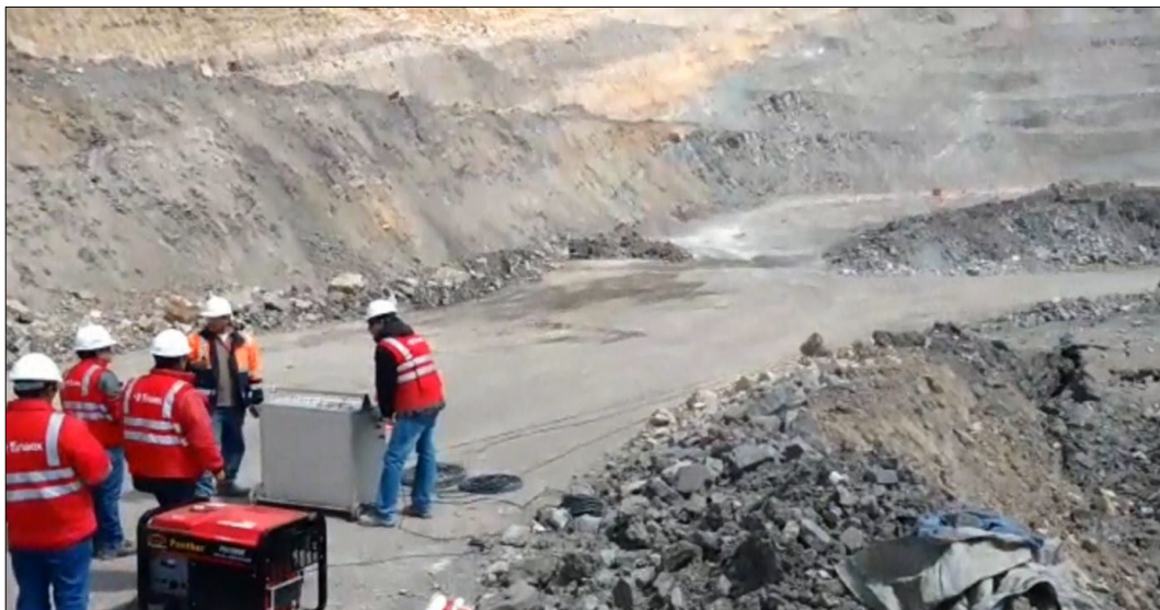
Ilustración 6. Iniciador eléctrico y multítester para la iniciación Fuente: ENAEX, 2019b.
