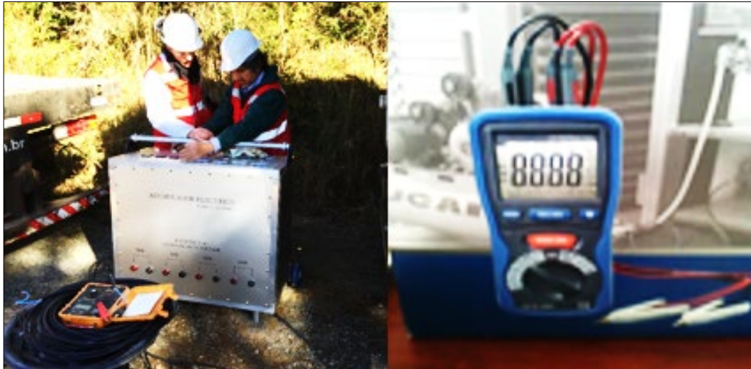
Ilustración 4. Inicializador eléctrico y multímetro para la iniciación Fuente: ENAEX, 2019b.
