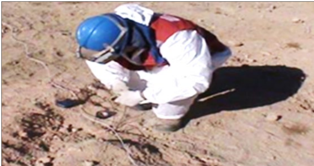
Ilustración 5. Chequeo de los taladros de perforación Fuente: ENAEX, 2019b.
