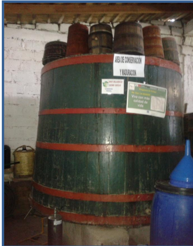
Barricas de madera usada para la fermentación del Vino – Agroindustrias Pocho Castillo
