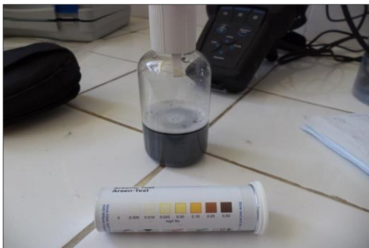
Figura 6. Proceso de reacción para la determinación de arsénico.
