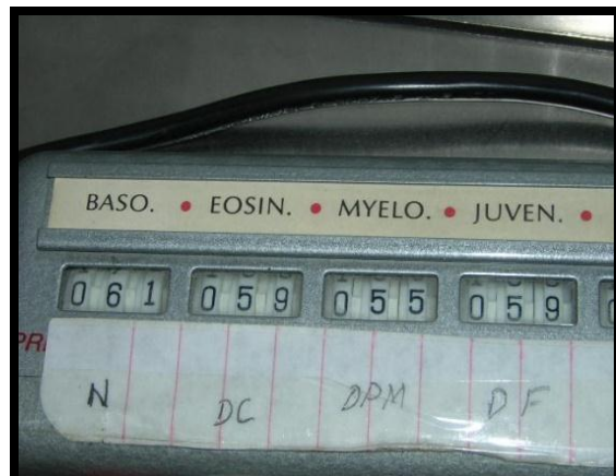
Contador de fórmula leucocitaria (Adaptado para la identificación morfológica de los espermatozoides)
