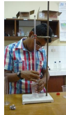
Foto 15: Determinación de cianuro libre en la solución barren – Método Titulométrico
