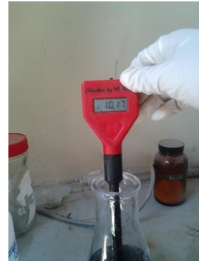
Foto 07: Estabilizando el pH del efluente líquido cianurado
