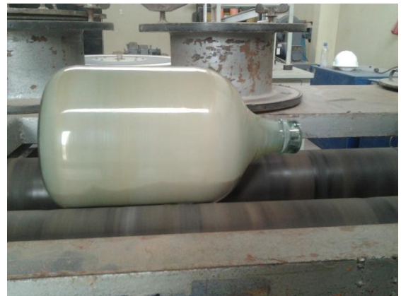
Foto 09: Homogenización del efluente líquido cianurado por 24 horas
