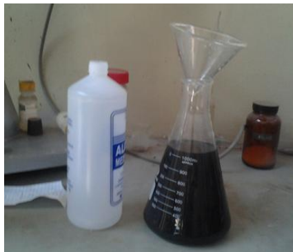
Filtrar el efluente líquido cianurado para separar la solución líquida del carbón activado
