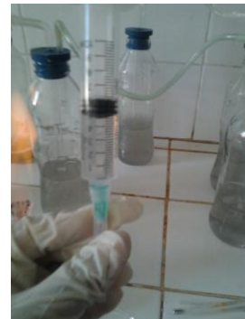
Foto 32: 5 ml de solución barren para la titulación con nitrato de plata, en un vaso precipitado
