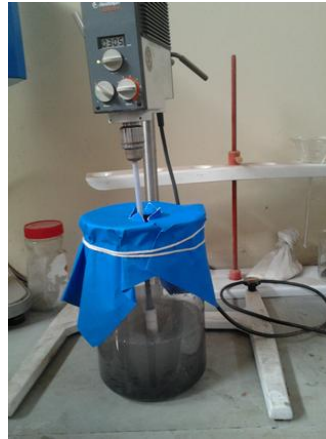
Extracción de oro Homogenizar a 305 rpm por 24 h
