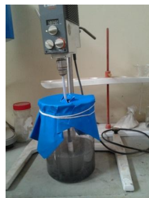
Foto 11: Solución cianurada con carbón activado a 305 rpm por 24 h
