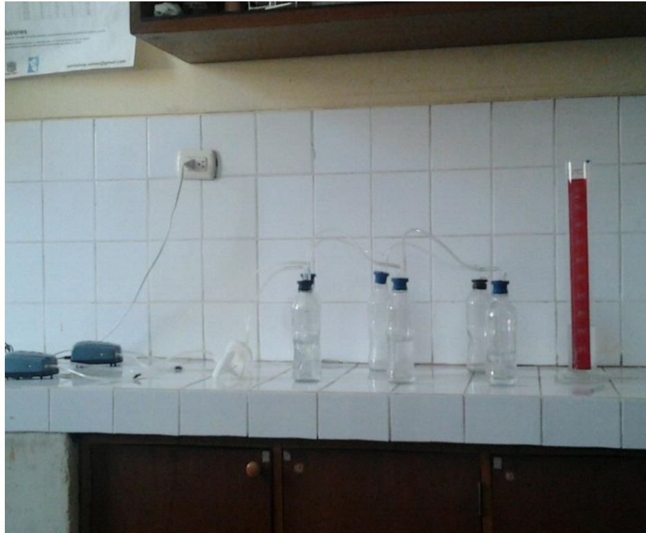
Foto 01: Biorreactores aireados durante el proceso de degradación de cianuro libre por Pseudomonas sp.
