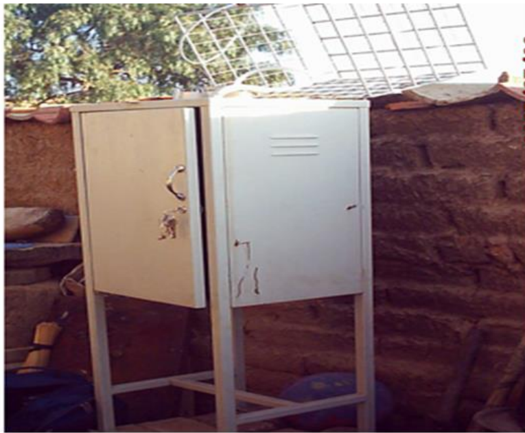
Figura 1: Equipo portátil Harvard de medición de gases.
