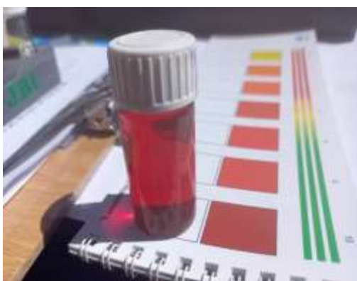
Análisis de agua insitu utilizando kit pro JBL AQUATEST
