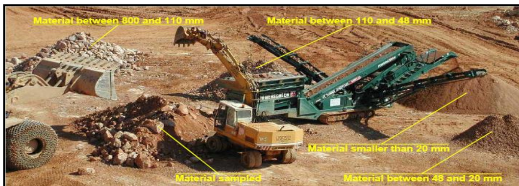
Figura 11. Vista general de una cribadora móvil, una cargadora y las pilas de material. Fuente: Bergman, 2005.
