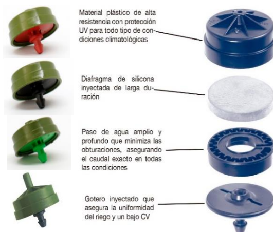
Figura 30. Gotero autocompensante PC. Fuente. Grupo Regaber, 2014.
