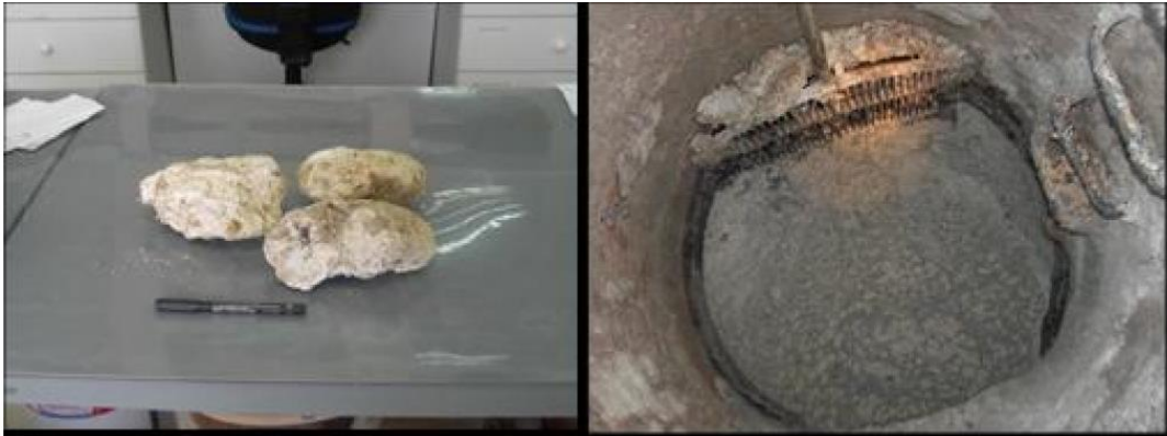
Figura 3. Izquierda, bolas de grasa; derecha, obstrucción de un colector con grasa en España
