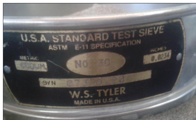
Figura 24. Tamiz de malla N° 30 Fuente: Laboratorio metalurgia, 2016.
