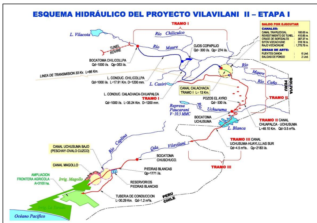
Figura 40: Esquema Hidráulico del Proyecto Vilavilani II Etapa I
