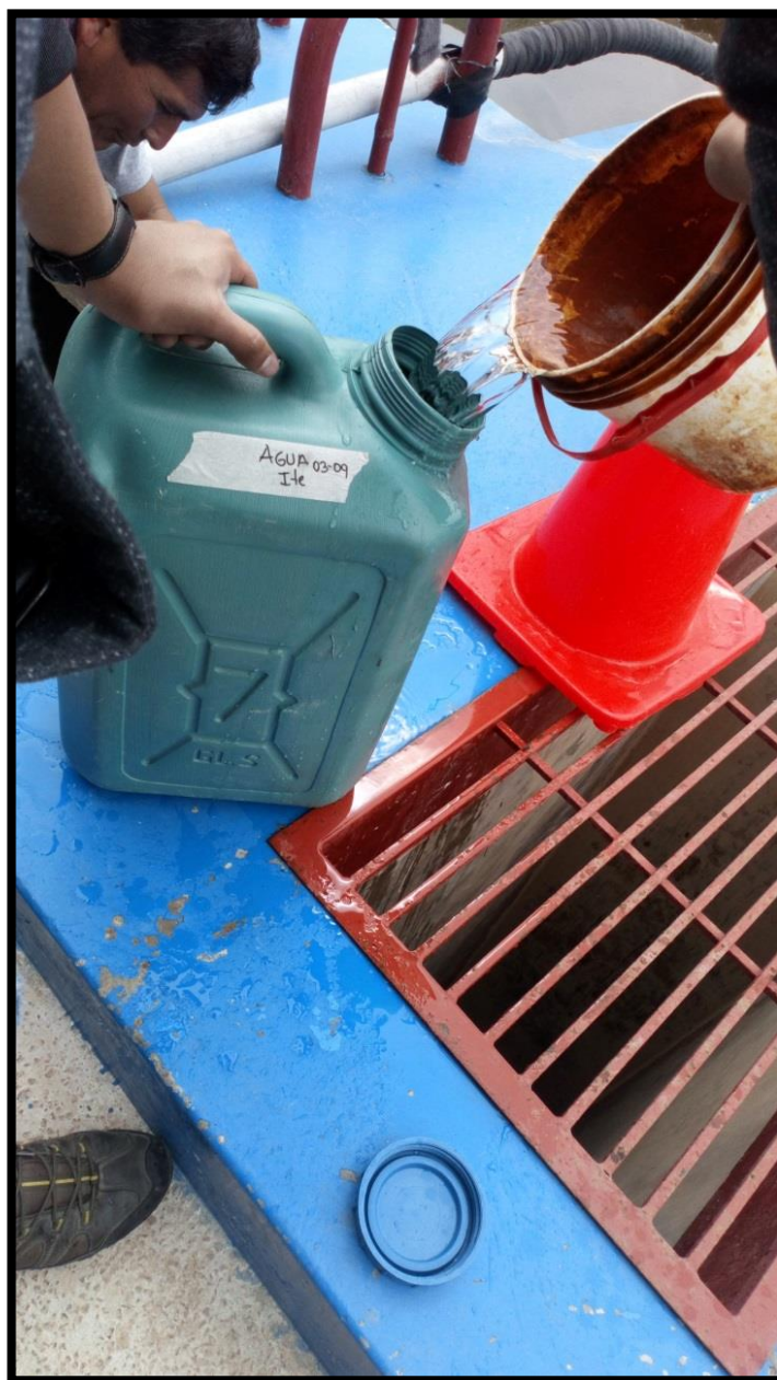
Figura 44. Captación del agua a tratar en laboratorio de la salida del filtro de la Planta de Tratamiento de Agua de Ite
