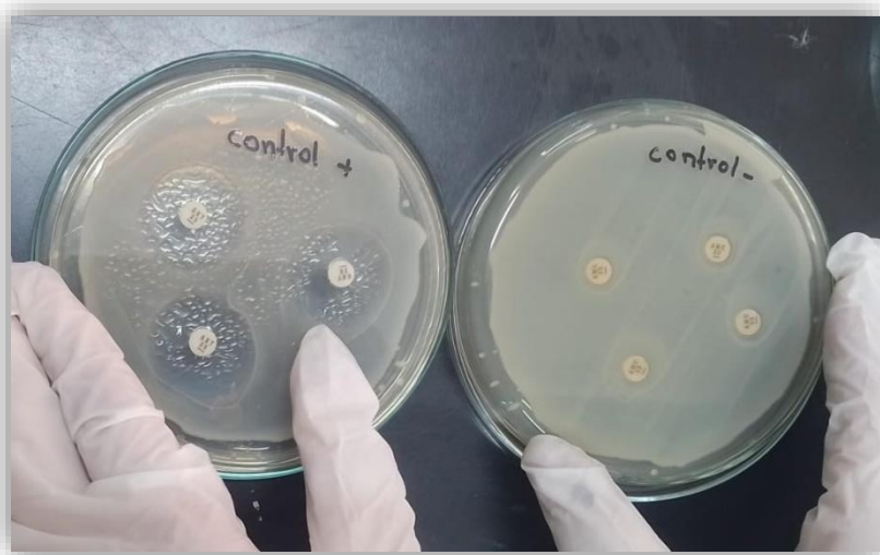
Anexo 17. Placas de control positivo y negativo para E. coli .
