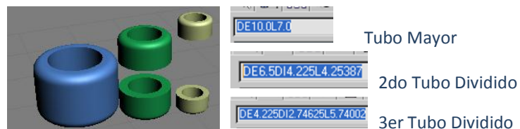
Figura 48. Medidas y nombres de cada pieza generada (Nomenclatura: DEXDIYLZ+NOMBRE ).
