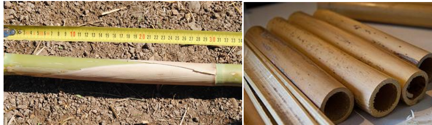
Figura 5. Medición de la longitud de trozos de caña (entrenudos).
