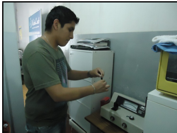
Fig. 12 Lectura de la absorbancia, en el espectrofotómetro absorción UV-visible.
