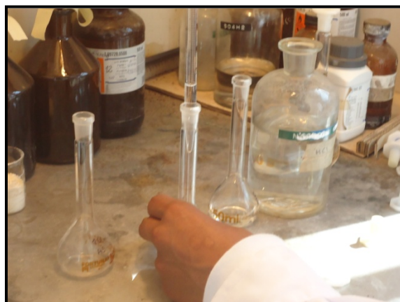
Fig. 6 Limpieza del material (Tratamiento con \text{HNO}_3 concentrado)
