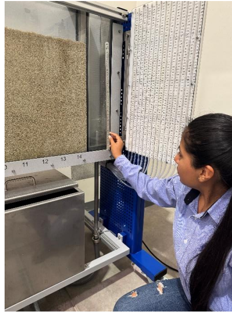
Medición con regla de la altura del tubo rebosadero derecho.
