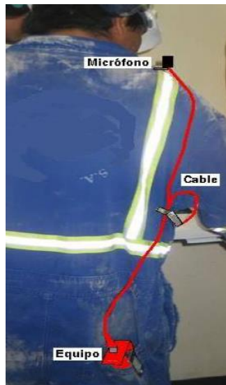
Figura 2. Instalación del dosímetro Fuente: Elaboración propia
