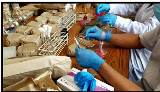
Figura 13. Verificación de la impregnación bacteriana e hisopado a cada instrumento de cada una de las bandejas Fuente. Elaboración propia
