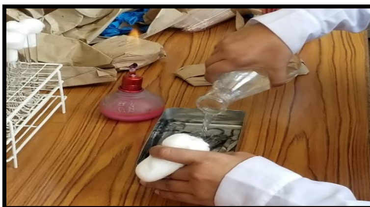
Figura 16. Contaminación de los instrumentos en un depósito estéril mediante sumersión con el inóculo y se le deja por 15 min. Fuente. Elaboración propia
