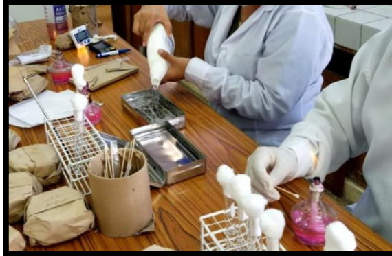
Figura 30. Desinfección con el Polihexametileno Guanidina 9 % por sumersión por 10 minutos. Fuente. Elaboración propia
