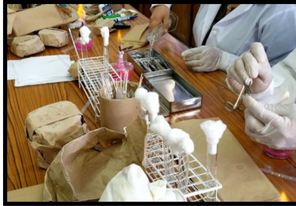
Figura 34. Se procede a la desinfección con el Hipoclorito de Sodio por sumersión por 5 minutos. Fuente. Elaboración propia
