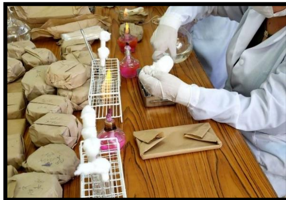
Figura 24. Contaminación de los instrumentos esterilizados en un depósito mediante sumersión con el inóculo.
