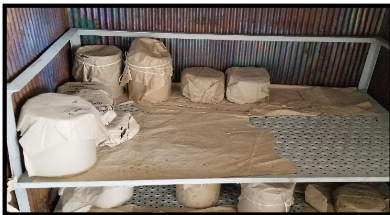
Figura 15. La muestra se coloca al final en la incubadora a 37° por 48 horas. Fuente. Elaboración propia
