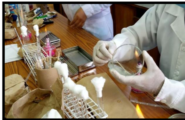
Figura 35. Toma de muestra con hisopado la cantidad UFC/gérmenes adheridos. Fuente. Elaboración propia
