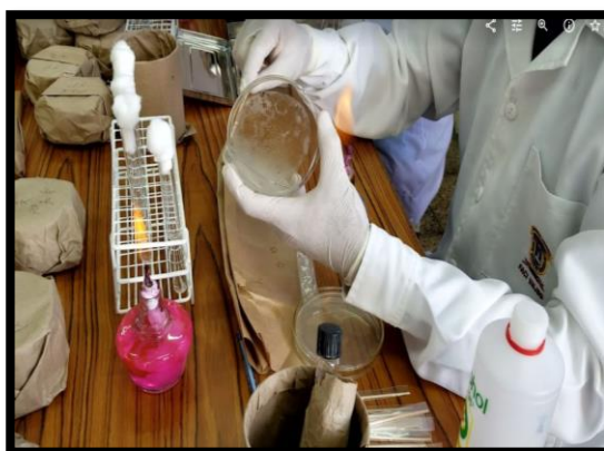
Figura 27. Tomar muestra de la cantidad UFC/gérmenes adheridos al instrumento. Fuente. Elaboración propia
