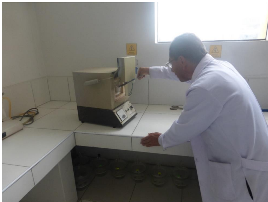
Figura 20. Mufla para la determinación de cenizas en las muestras de espinaca.
