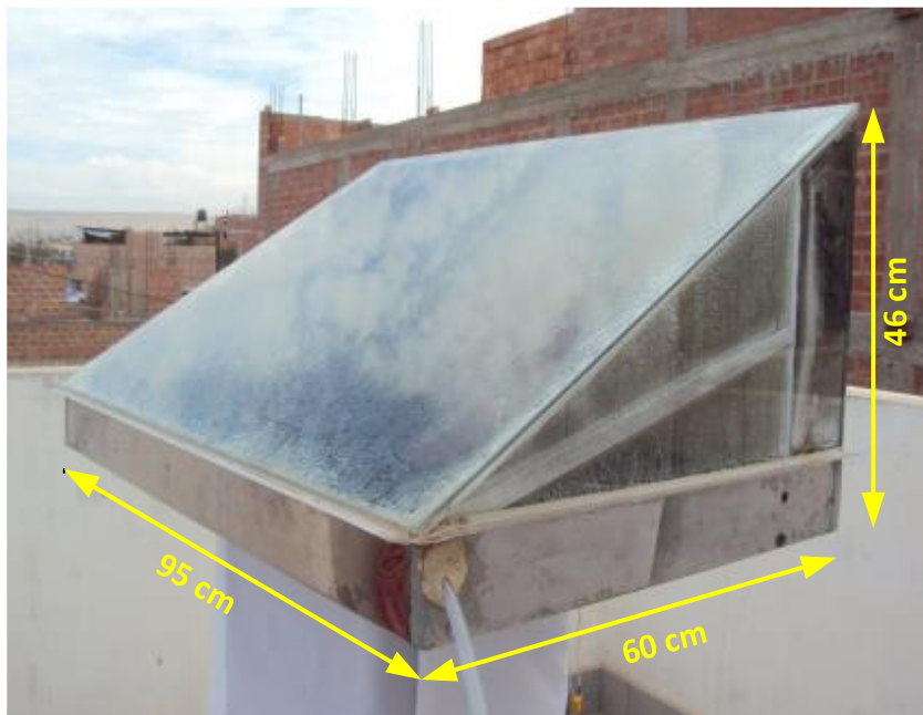
Figura 3. Destilador solar tipo caja de una sola vertiente.
