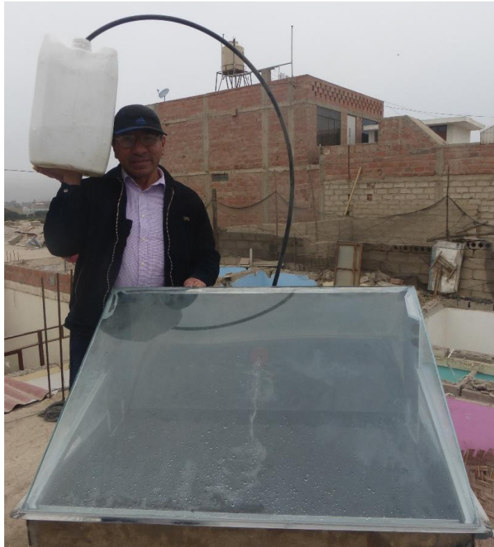
Figura 9. Agua de mar para el desalinizador.
