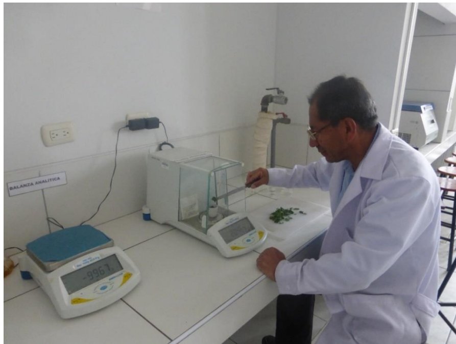
Figura 19. Balanza analítica utilizada para la determinación de cenizas de espinacas.
