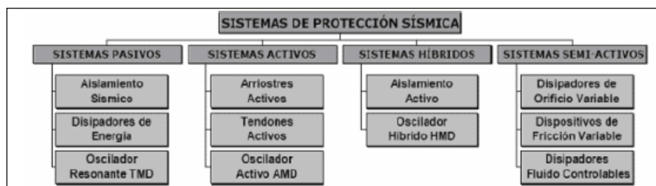
Figura 07. Sistemas de protección sísmica
