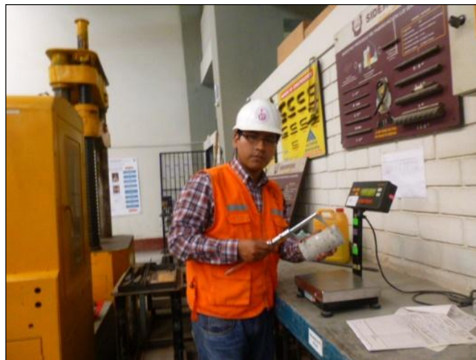
Figura 64. Medición de dimensiones de testigos diamantinos. Fuente: Elaboración propia.
