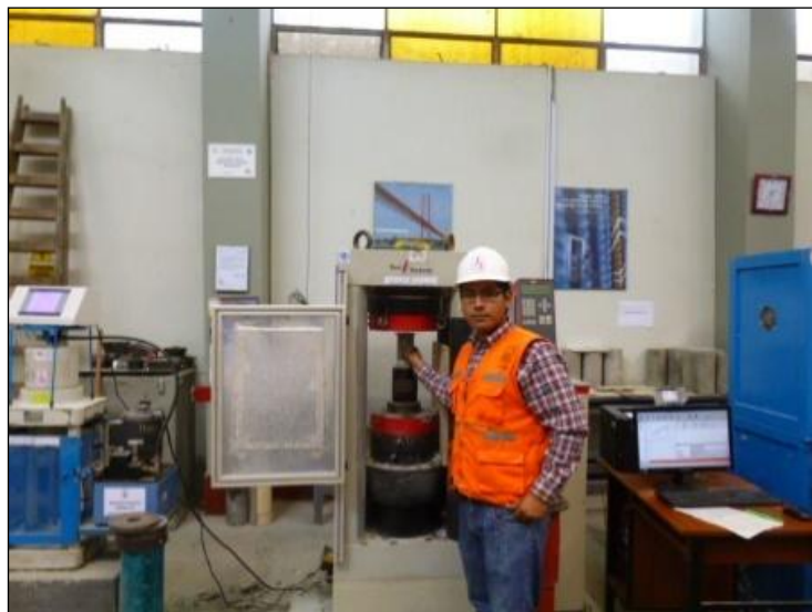
Figura 24. Ensayo de Testigos Diamantinos realizado en la UNI. Fuente: Elaboración propia.
