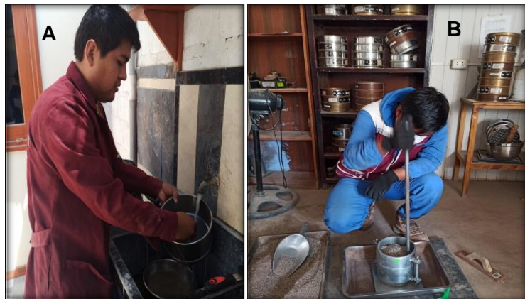
Foto N° 18: (A) Ensayo de lavado del agregado fino por el tamiz #200. (B) Ensayo densidad máxima y mínima de los agregados, método vallado.
