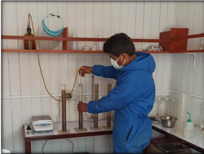
Foto N° 21: Ensayo de equivalente de arena, agregado fino.
