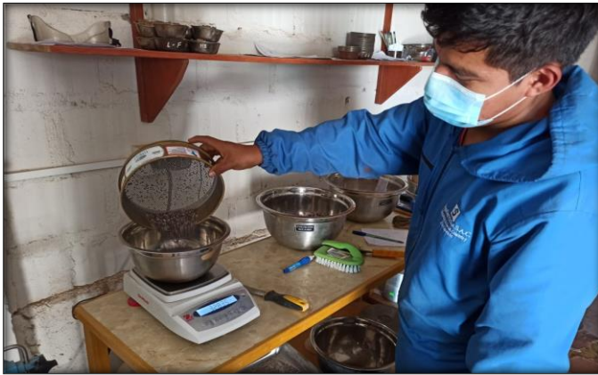
Foto N° 17: Ensayo se análisis granulométricos por tamizado de los agregados, pesaje de muestras retenidas.
