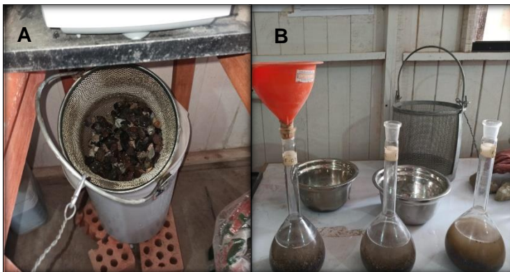
Foto N° 19: (A) Ensayo de peso específicos para el agregado grueso. (B) Ensayo de peso específico para el agregado fino.
