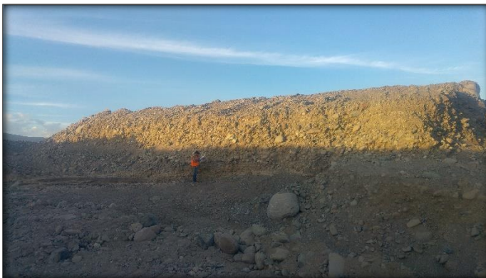
Foto N° 7: Banco de material aluvial conformados por bloques disperso, cantos, gravas y arenas Cantera Cerro blanco, zona piedra blanca.
