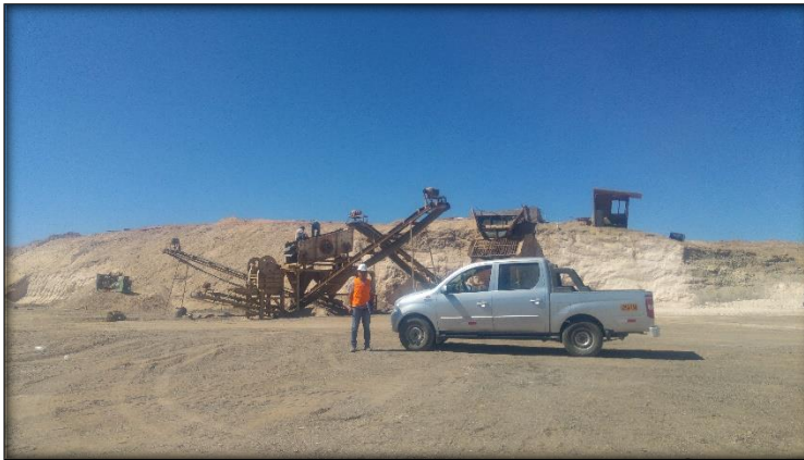
Foto N° 14: Extracción del material en bruto de los bancos aluviales para su posterior carguío a la planta procesadora. Se puede observar la potencia del estrato explotado. Cantera Moran.
