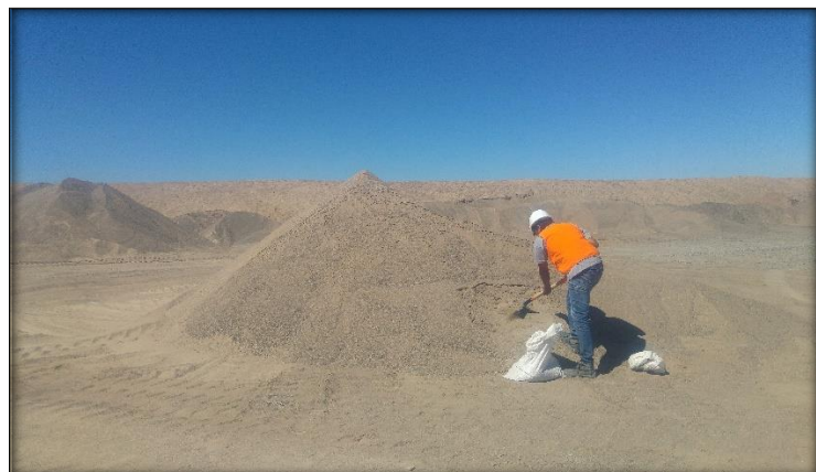
Foto N° 15: (A) Muestreo del material en bruto de la cantera Moran. En la base del estrato de puede observar afloramientos de ceniza volcánica. (B) Clastos naturales angulosos a sub angulosos.
