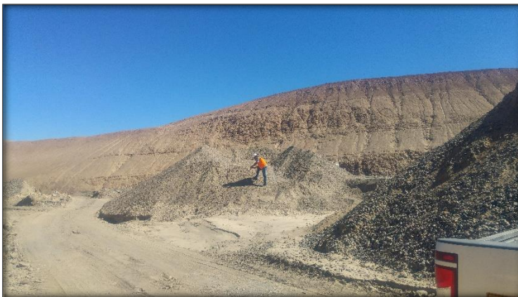
Foto N° 11: Rumas de acumulación del producto final (agregados) de la cantera salida tarata, se procedió a realizar el muestreo y transporte del material en bruto y producido.
