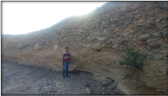
Foto N° 5: Potencia de del material bruto, tamaño y forma de partículas de los clastos, cantera Río seco.
