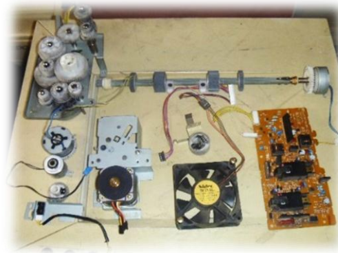
Figura 9. Mecanismos, TCI y motor paso a paso de una impresora matricial
