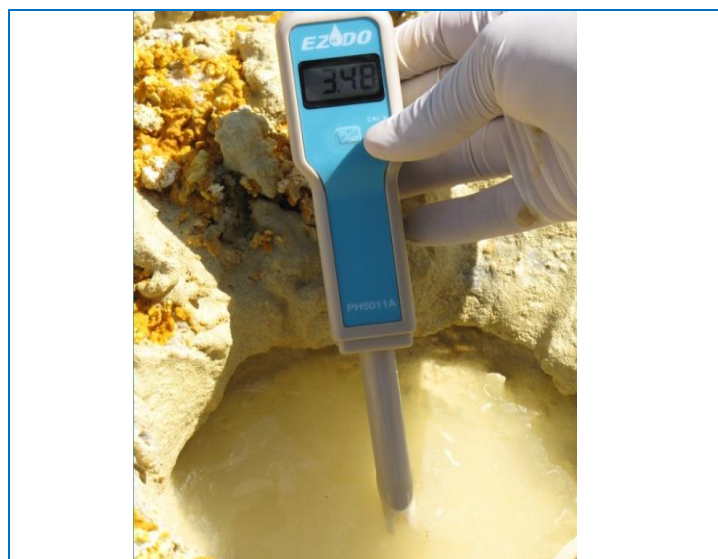
Figura 20. pH-metro que permitió las mediciones de las muestras.
