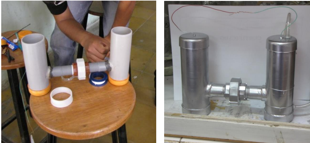
Figura 21. Construcción de la MFC de dos cámaras tipo "H".
