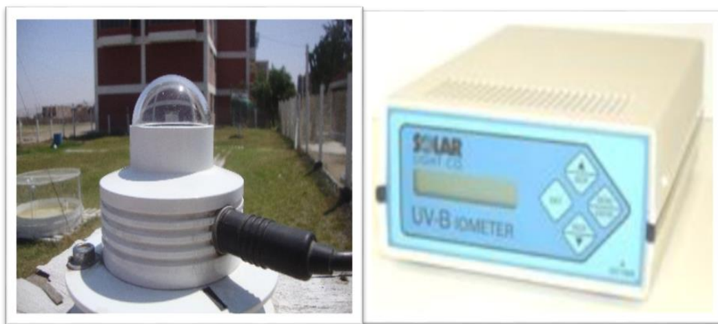
Figura 12. Biómetro, instrumento de medición de la radiación ultravioleta UV, modelo solar light 501 Fuente: SENAMHI
